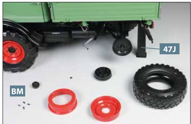
**12** Nehmen Sie das linke Hinterrad ab und bauen Sie es auseinander. Die Schrauben **BM** bewahren Sie auf. Bocken Sie die Hinterachse mit einem hinteren Träger **47J** auf.
