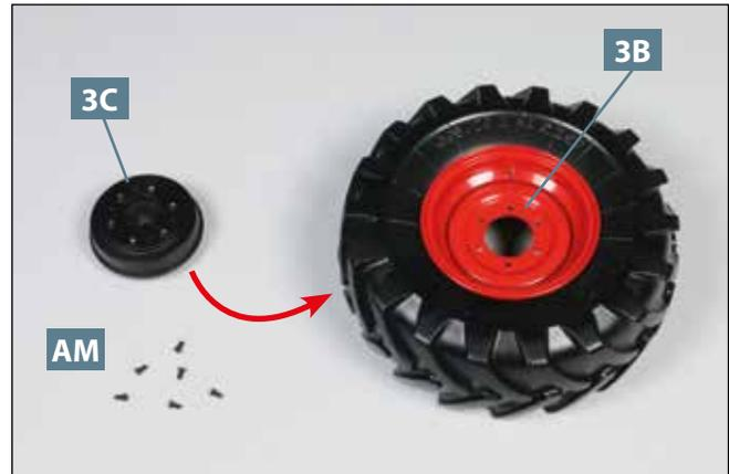
**08** Legen Sie sechs der diesmal gelieferten Schrauben **AM** bereit. Führen Sie die Bremstrommel **3C** von unten zu den vertieften Aufnahmen des Scheibenrads **3B**, wie angedeutet.
