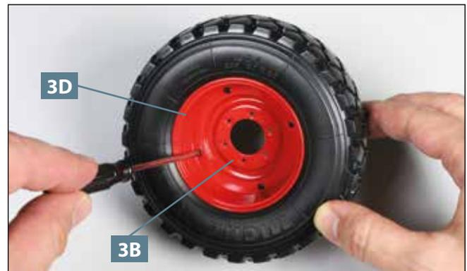
**04** Entfernen Sie die vier Schrauben **BM** aus den beiden Scheibenrädern **3B** und **3D**.
