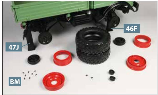
**14** Wechsel auf die rechte Modellseite. Bocken Sie die Achsen mit je einem Träger **46F** und **47J** auf. Nehmen Sie die beiden Räder ab und bauen Sie sie auseinander. Die Schrauben **BM** bewahren Sie auf.
