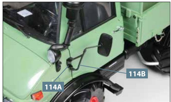
**02** Auf der linken Fahrerhausseite bringen Sie den Halter des Seitenspiegels **114B** an der Aufnahme **114A** an.
