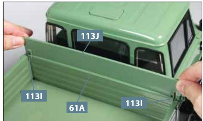
**16** Bringen Sie die Vorderwand-Erhöhung **113J** an der Pritsche an. Schieben Sie dazu die beiden Befestigungsfüße **113I** über die Oberkante der Vorderwand **61A**.
