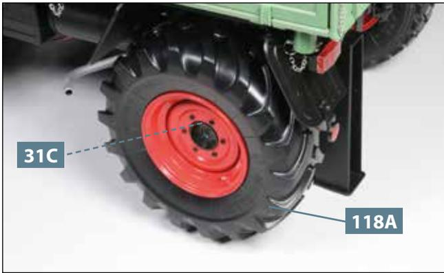
**13** Bauen Sie das zweite Ackerstollenrad **118A** zusammen und befestigen Sie es am Zapfen des Vorgelegegehäuses **31C**. Die Montage entspricht exakt den Schritten 06–11.
