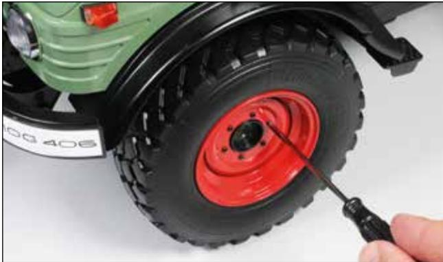
**01** Falls Sie die Straßen- gegen die Ackerstollenbereifung austauschen möchten, können Sie dies nun tun. Der Radwechsel wird exemplarisch am linken Vorderrad gezeigt. Lösen Sie zunächst die sechs Schrauben **AM**.
