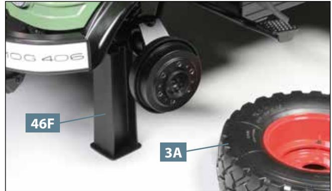
**02** Nehmen Sie das linke Vorderrad **3A** ab und bocken Sie die Vorderachse mit einem Träger **46F** auf.
