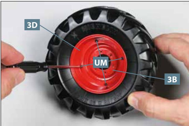
**07** Fixieren Sie die beiden Scheibenräder **3B** und **3D** mithilfe von vier Schrauben **UM** aneinander.
