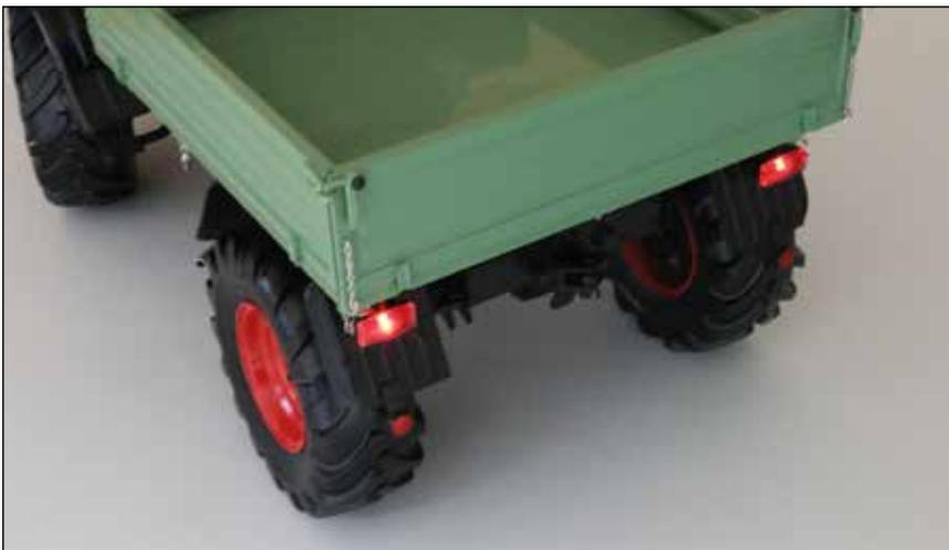
**02** Die Fotos zeigen die aufleuchtenden Frontscheinwerfer und Schlussleuchten. Drücken Sie das Bremspedal durch, leuchtet die Schlussleuchte heller auf.
