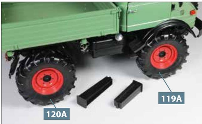
**15** Bauen Sie die Ackerstollenräder **119A** und **120A** zusammen und befestigen Sie sie am Modell. Die Montage entspricht den Schritten 06–11. Entfernen Sie alle vier Stützen.
