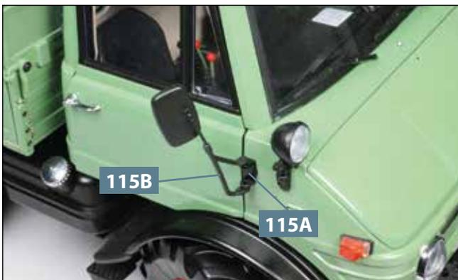
**01** Auf der rechten Seite des Fahrerhauses wird der Halter des Seitenspiegels **115B** an der Aufnahme **115A** befestigt.
