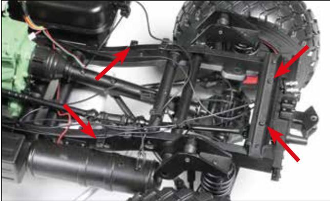
**01** Nun wird die Pritsche auf das Chassis gesetzt. In diesem Bild sind die vier Stellen mit Pfeilen markiert, an denen die Pritsche mit dem Chassis verschraubt wird.
