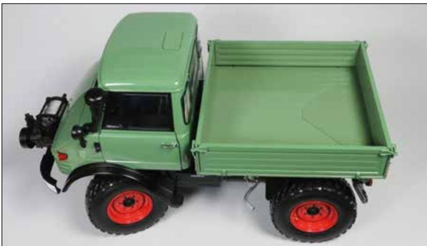
Die Pritsche ist auf dem Chassis platziert und mit diesem verschraubt. Die Bremslichtkabel sind wieder angeschlossen.
