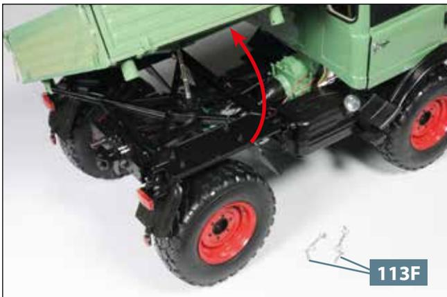
**15** Nun wird die rechte Seite der Pritsche hochgeklappt. Entfernen Sie dazu zuvor die beiden entsprechenden Steckbolzen **113F**, wie abgebildet.
