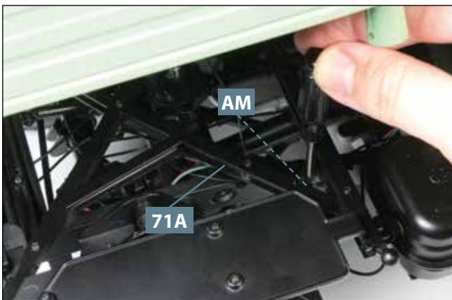
**17** Mit der vierten und letzten Schraube **AM** fixieren Sie den Hilfsrahmen **71A** vorne rechts am Chassis.
