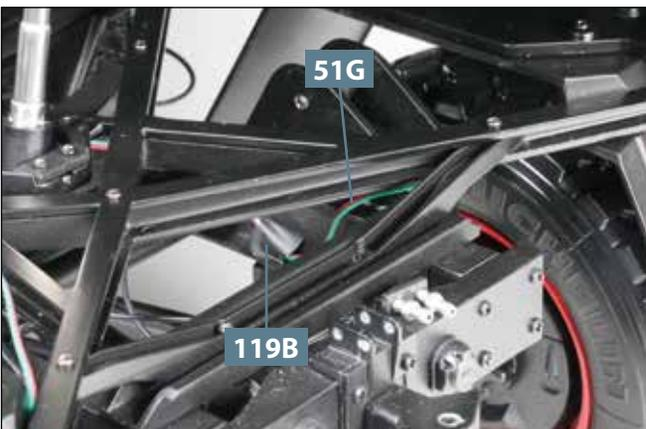
**11** Führen Sie das Kabel vom rechten Bremslicht **51G** am rechten Längsträger weiter nach hinten und fixieren Sie es an ihm mit einem Klebestreifen **119B**.
