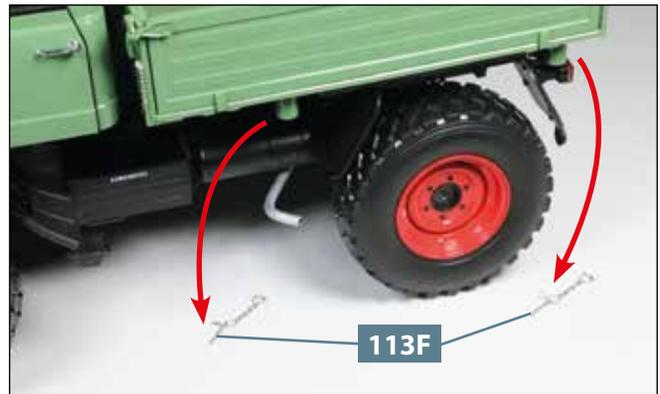
**04** Ziehen Sie die beiden Steckbolzen **113F** heraus, die sich auf der linken Seite des Modells befinden.
