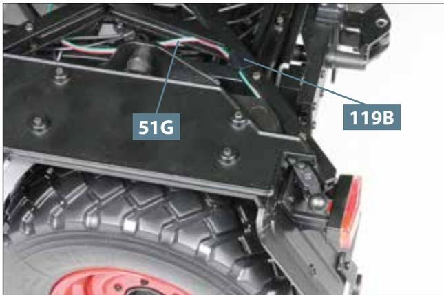
**13** Wechsel zum Kabel vom linken Bremslicht **51G**: Dieses wird mit einem Klebestreifen **119B** an der gegenüberliegenden Diagonalstrebe des Hilfsrahmens befestigt.
