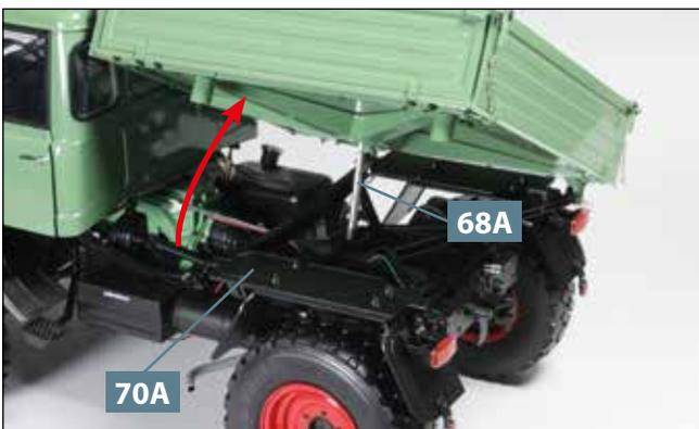
**05** Halten Sie den Hilfsrahmen **70A** in Position, während Sie die linke Seite der Pritsche solange hochdrücken, bis der Hydraulikzylinder **68A** vollständig ausgefahren ist.
