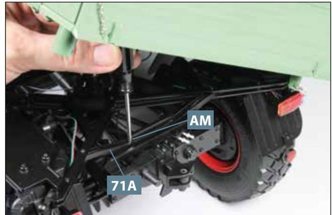
**08** Hinten wird der Hilfsrahmen **71A** mit einer weiteren Schraube **AM** am Chassis fixiert, wie es das Foto zeigt.
