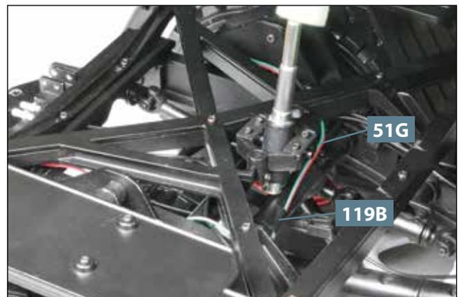
**18** Das Kabel, das zum linken Bremslicht **51G** führt, können Sie mit einem oder mehreren weiteren Klebestreifen **119B** am Chassis bzw. am Hilfsrahmen befestigen, sodass es möglichst wenig sichtbar ist.
