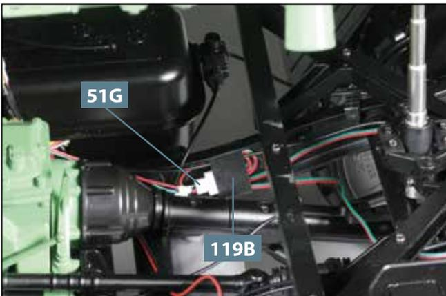
**09** Nehmen Sie einen der Klebestreifen **119B** und fixieren Sie mit diesem das Kabel **51G** im Hohlraum an der Innenseite des rechten Längsträgers, wie abgebildet.
