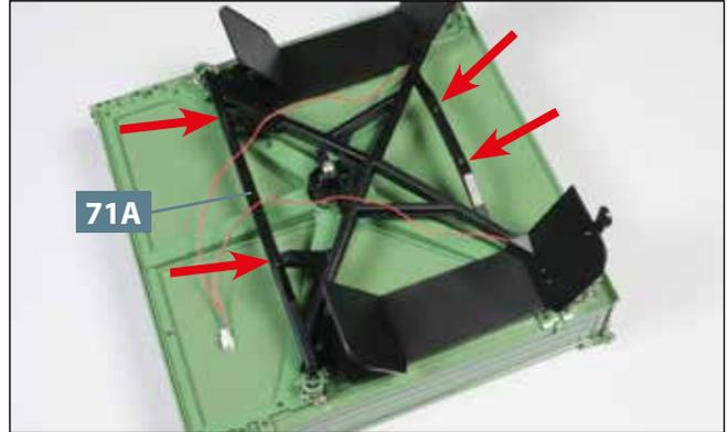
**02** Legen Sie die Pritsche verkehrt herum auf Ihre Arbeitsplatte. Mit Pfeilen markiert sind die Stellen, an denen der Hilfsrahmen **71A** mit dem Chassis verschraubt wird.
