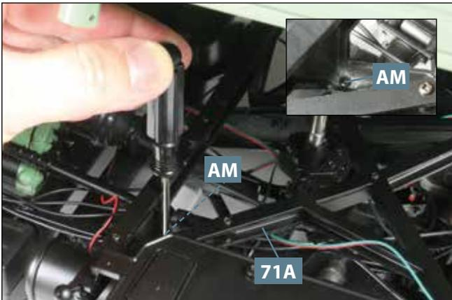
**07** Fixieren Sie den Hilfsrahmen **71A** mit einer Schraube **AM** am Chassis. Das Detailbild zeigt die in der Vertiefung sitzende Schraube ganz deutlich.
