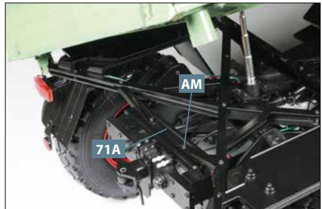
**16** Hinten wird der Hilfsrahmen **71A** mit einer weiteren Schraube **AM** am Chassis fixiert, wie abgebildet.
