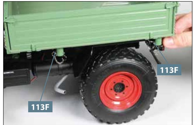
**14** Drücken Sie die linke Seite der Pritsche wieder herunter und sichern Sie sie, indem Sie die beiden Steckbolzen **113F** wieder einsetzen und sichern, wie abgebildet.
