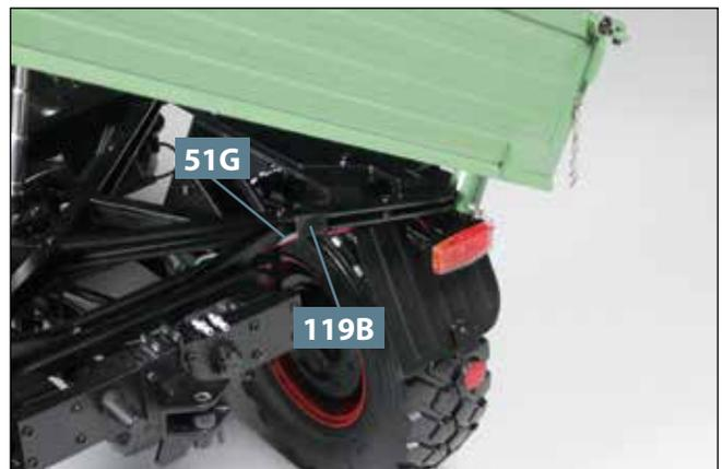
**12** Mit einem weiteren Klebestreifen **119B** wird das Kabel vom rechten Bremslicht **51G** hinten an der diagonal verlaufenden Strebe des Hilfsrahmens befestigt.
