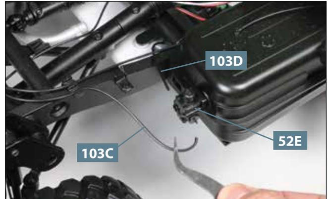
**02** Lösen Sie die beiden Schläuche **103C** und **103D** von den entsprechenden Zapfen des Vorfilters **52E** am Kraftstofftank, wie abgebildet.
