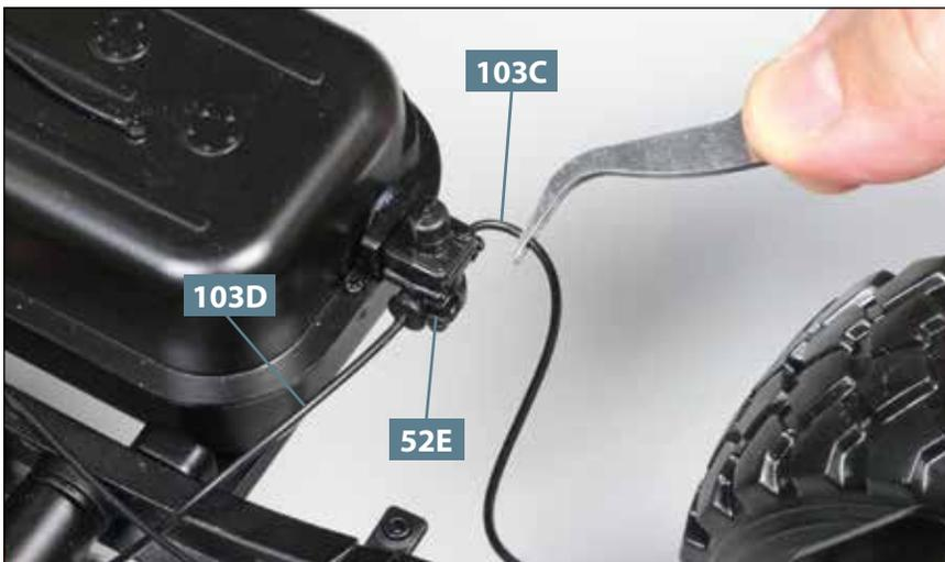
**05** Verbinden Sie die beiden Schläuche **103C** und **103D** wieder mit den Zapfen des Vorfilters **52E**, wie es das Foto zeigt.
