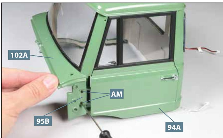
**02** Fixieren Sie die Türhalterung **95B** mit zwei Schrauben **AM** am Fahrerhaus **102A**. Die linke Tür **94A** ist somit am Fahrerhaus angebracht, wie abgebildet.
