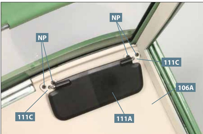
**09** Befestigen Sie die linke Sonnenblende **111A** an der Dachverkleidung **106A**, indem Sie je zwei Schrauben **NP** in die Bohrungen der Halterungen **111C** eindrehen, wie es das Foto zeigt.
