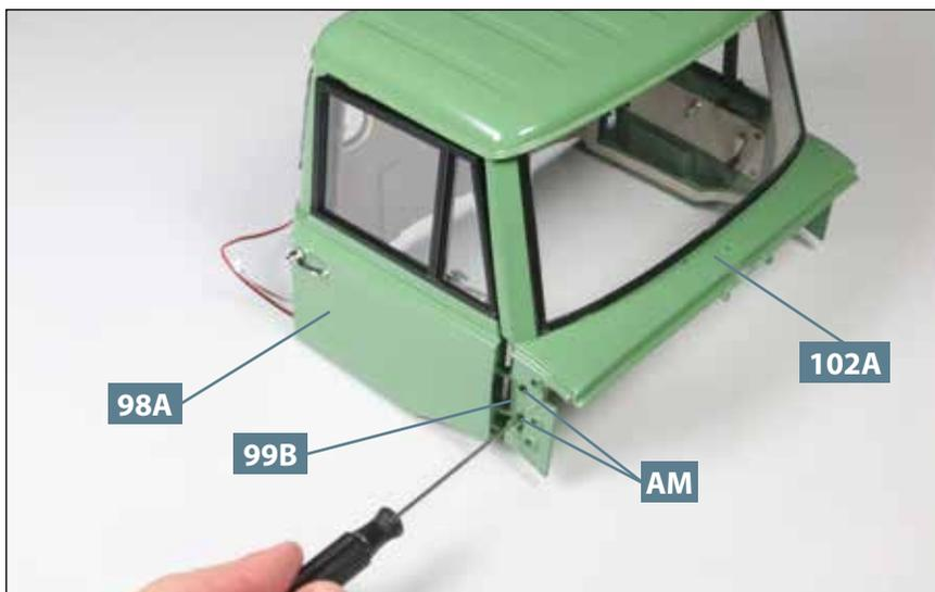
**04** Die rechte Tür **98A** ist in das Fahrerhaus **102A** eingesetzt. Fixieren Sie die Türhalterung **99B** mit zwei Schrauben **AM**.
