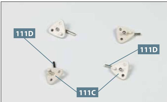
**03** Fügen Sie zwei weitere Bügel-Halterungs-Paare **111C/111D** zusammen. Somit erhalten Sie vier identische Bauteilpaare, wie abgebildet.
