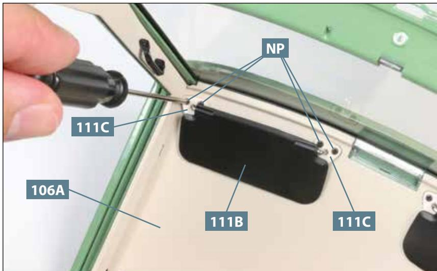
**10** Auf der anderen Seite der Dachverkleidung **106A** wird die rechte Sonnenblende **111B** montiert: Ihre beiden Halterungen **111C** werden dazu ebenfalls mit je zwei Schrauben **NP** fixiert.
