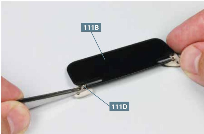
**07** Der letzte verbliebene Bügel **111D** wird am „langen“ Ende der rechten Sonnenblende **111B** angebracht.
