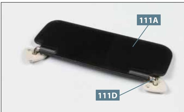
**05** Am „langen“ Ende der linken Sonnenblende **111A** wird ebenfalls einer der Bügel **111D** eingesetzt.
