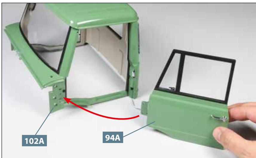
**01** Drehen Sie das Fahrerhaus **102A** vorsichtig um. Nehmen Sie die linke Tür **94A** und führen Sie sie zur Öffnung auf der linken Seite des Fahrerhauses, wie es der Pfeil andeutet.
