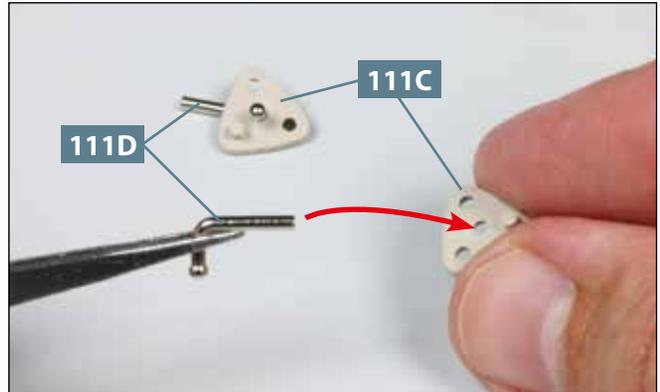
**02** Der erste Bügel **111D** ist in die erste Halterung **111C** eingefügt. Wiederholen Sie den Schritt mit dem zweiten Bügel-Halterungs-Paar, wie abgebildet.
