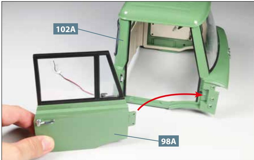
**03** Wechsel auf die andere Seite des Fahrerhauses **102A**: Nehmen Sie die rechte Tür **98A** und führen Sie sie zur großen Aussparung auf der rechten Fahrerhausseite, wie es der Pfeil andeutet.
