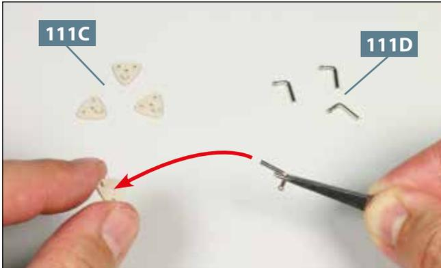
**01** Legen Sie die vier Halterungen **111C** und die vier Bügel **111D** auf Ihre Arbeitsplatte. Fügen Sie den Schaft des ersten Bügels in die Bohrung der ersten Halterung, wie angedeutet.
