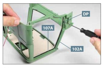
**02** Fixieren Sie die linke Fahrerhausverkleidung **107A** von außen mit einer Schraube **DP** am Fahrerhaus **102A**.
