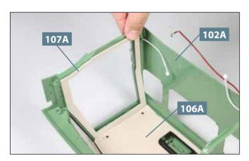
**01** Stellen Sie das Fahrerhaus **102A** verkehrt herum auf Ihre Arbeitsplatte. Setzen Sie die linke Fahrerhausverkleidung **107A** so ein, dass sich die Laschen an ihrer Oberkante in die Aussparungen der Dachverkleidung **106A** einfügen.
