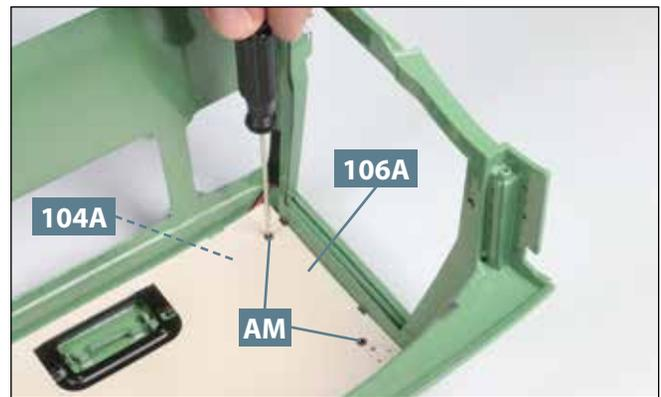
**10** Das rechte Ende der Dachverkleidung **106A** wird ebenfalls mit zwei Schrauben **AM** am Dach **104A** befestigt.
