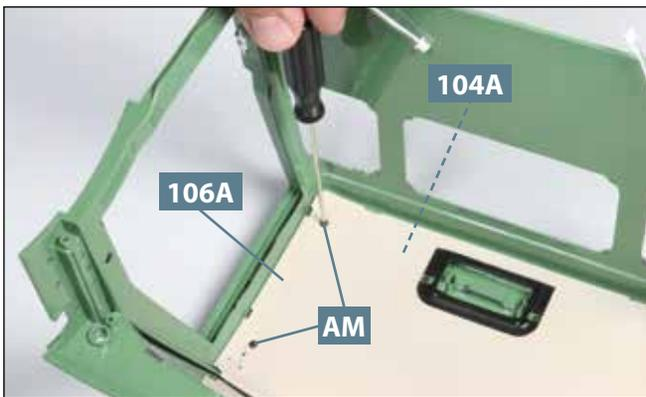
**09** Fixieren Sie das linke Ende der Dachverkleidung **106A** mit zwei Schrauben **AM** am Dach **104A**.
