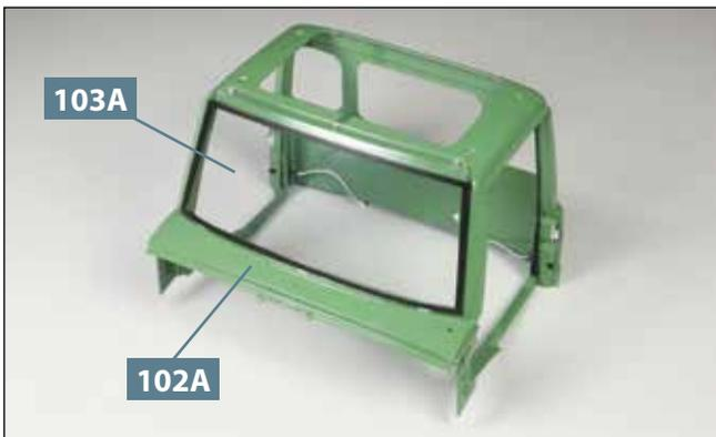
**05** Stellen Sie das Fahrerhaus **102A** auf Ihre Arbeitsplatte. Nehmen Sie die Frontscheibe **103A** und platzieren Sie sie von außen in der großen Aussparung des Fahrerhauses.
