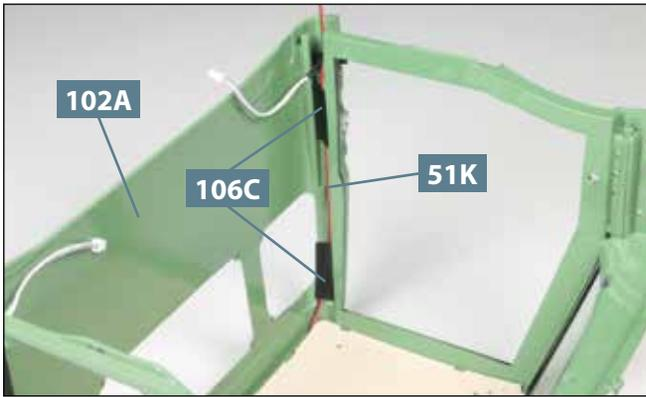
**07** Befestigen Sie das Kabel **51K** mit zwei Klebestreifen **106C** in der Vertiefung rechts hinten im Fahrerhaus **102A**.
