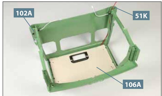
**06** Stellen Sie das Fahrerhaus **102A** vorsichtig auf den Kopf. Setzen Sie die Dachverkleidung **106A** in das Fahrerhaus ein, ausgerichtet wie abgebildet. Fügen Sie das Kabel **51K** in die Vertiefung rechts hinten im Fahrerhaus ein.
