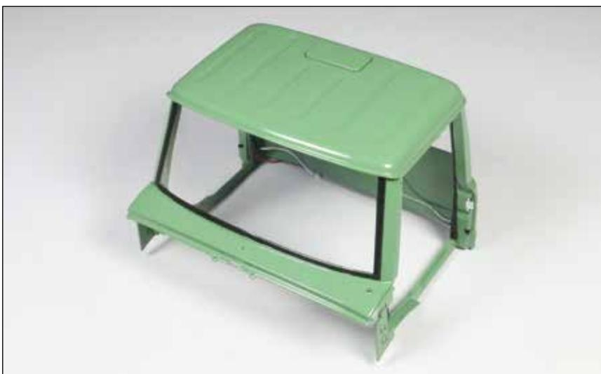
Am Fahrerhaus wurden die Dachverkleidung, die Deckenleuchte, die Frontscheibe und das Dach befestigt.
