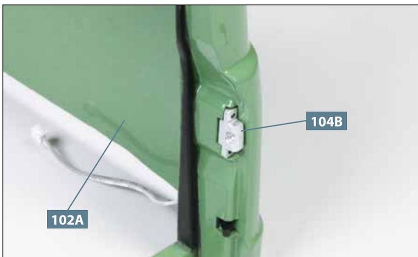
**02** Der Zapfen an der Rückseite der linken Türverriegelung **104B** ist in die Bohrung auf der linken Seite des Fahrerhauses **102A** eingefügt.
