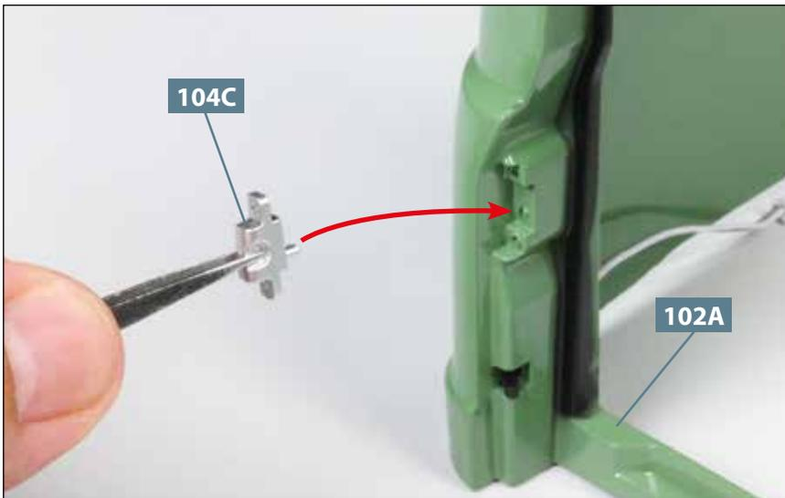
**04** Drehen Sie das Fahrerhaus **102A** um. Nehmen Sie die rechte Türverriegelung **104C** (mit eingraviertem „R“) und fügen Sie ihren Zapfen in die Bohrung auf der rechten Seite des Fahrerhauses ein, wie angedeutet.
