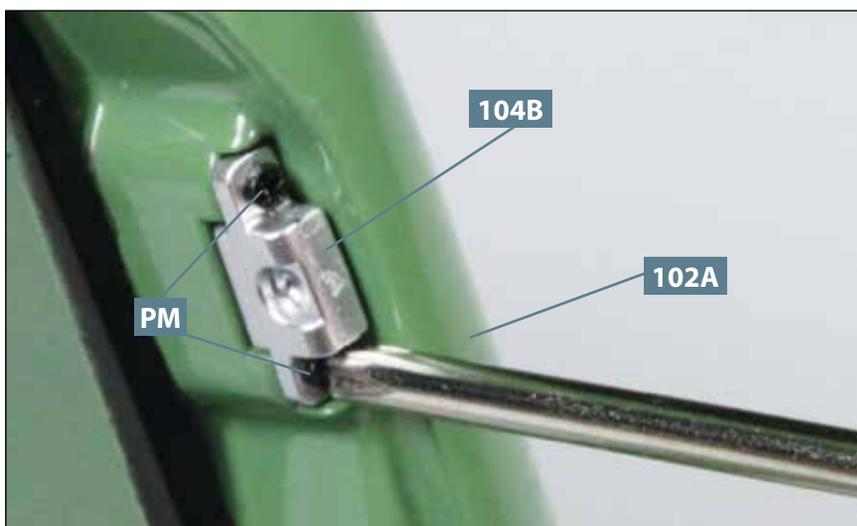
**03** Fixieren Sie die linke Türverriegelung **104B** mit den zwei Schrauben **PM** am Fahrerhaus **102A**, wie abgebildet.
