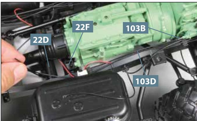
**03** Befestigen Sie den etwas längeren Schlauch **103D** am Anschluss **103B**. Er wird unter den beiden Querträgern **22F** und **22D** durchgeführt, wie abgebildet.
