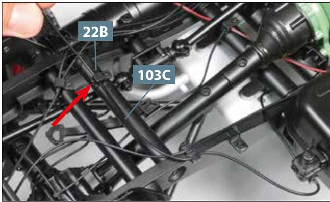
**07** Anschließend wird der Schlauch **103C** durch die Öffnung der Führung **22B** hindurchgeschoben (Pfeil) und zur anderen Seite des Rahmens geführt.
