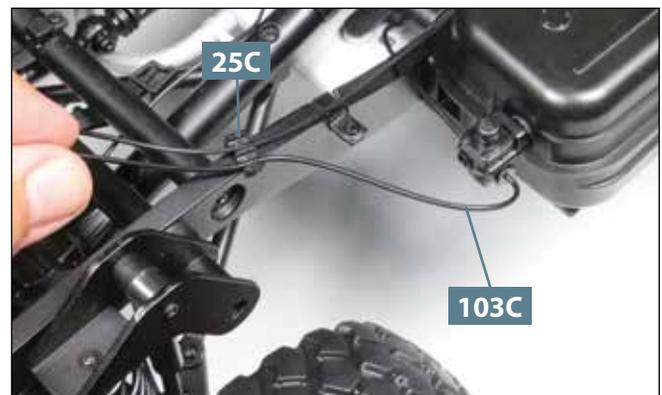
**06** Drücken Sie den Schlauch **103C** vorsichtig in die äußerste Vertiefung der Schlauchführung **25C** hinein.
