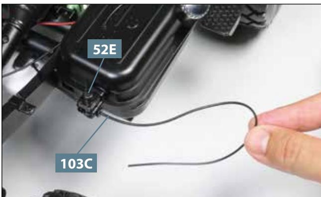
**05** Am äußeren Zapfen des Vorfilters **52E** befestigen Sie den etwas kürzeren Schlauch **103C**, wie es das Foto zeigt.
