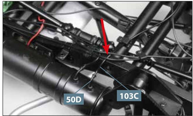
**08** Führen Sie den Schlauch **103C** unter den beiden Leitungen durch, auf die der Pfeil weist. Das freie Ende des Schlauchs befestigen Sie am hinteren Anschluss **50D** des Druckluftbehälters.
