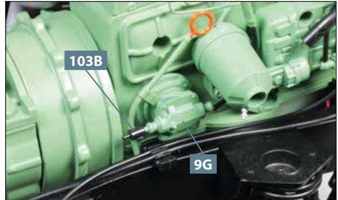
**02** Der Anschluss **103B** ist am Zapfen befestigt, der sich an der Hinterseite des Luftpressers **9G** befindet.
