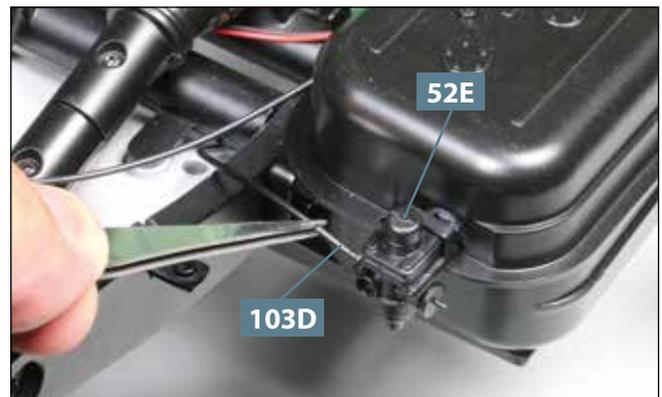
**04** Das hintere Ende vom Schlauch **103D** wird am inneren Zapfen des Vorfilters **52E** befestigt, wie abgebildet.
