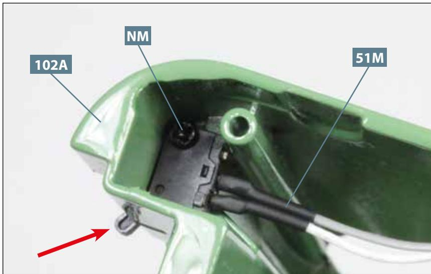
**04** Fügen Sie den Schalter **51M** in die Aussparung an der rechten hinteren Ecke des Fahrerhauses **102A** ein. Der Schalter, auf den der Pfeil weist, sitzt in dem Schlitz des Fahrerhauses. Fixieren Sie das Bauteil mit einer Schraube **NM**.
