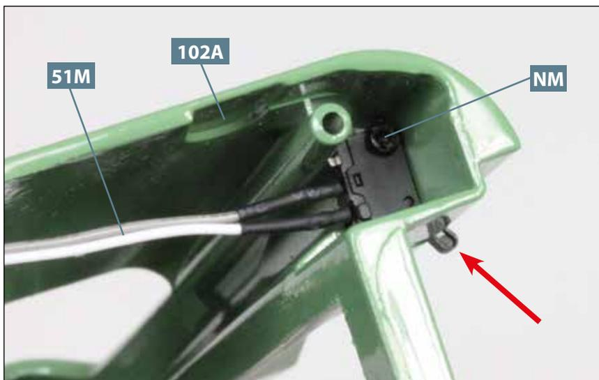
**05** Der andere Schalter **51M** wird in die Aussparung an der linken hinteren Ecke des Fahrerhauses **102A** eingefügt und ebenfalls mit einer Schraube **NM** befestigt. Auch hier muss der Schalter aus dem Schlitz des Fahrerhauses herausragen: Der Pfeil weist auf den Schalter.
