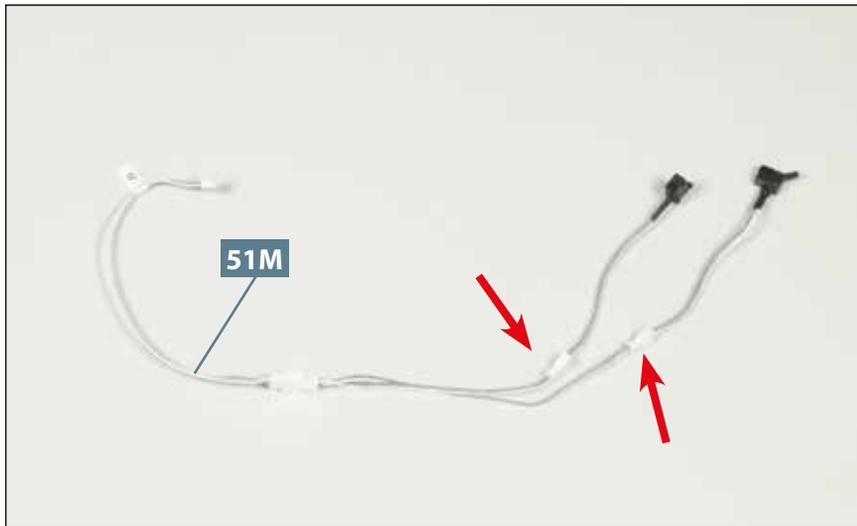
**01** Legen Sie das Kabel mit den beiden Deckenlichtschaltern **51M** auf Ihre Arbeitsplatte. Für die Bauschritte dieser Bauanleitung müssen die beiden Enden mit den Schaltern vom Rest des Kabels getrennt werden: Die beiden Pfeile weisen auf die Stellen.
