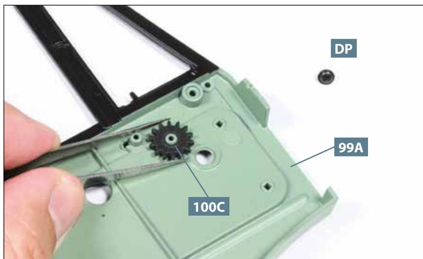
**02** Nehmen Sie das Zahnrad **100C** und platzieren Sie es auf dem abgebildeten Zapfen der Türverkleidung **99A**.
