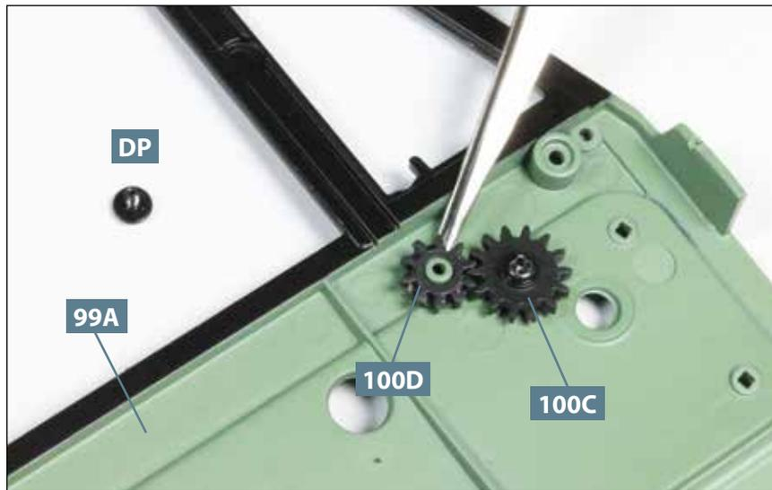
**04** Legen Sie eine weitere Schraube **DP** bereit. Nehmen Sie das Zahnrad **100D** und platzieren Sie es auf dem benachbarten Zapfen der Türverkleidung **99A**. Seine Zähne greifen in die des Zahnrads **100C**.
