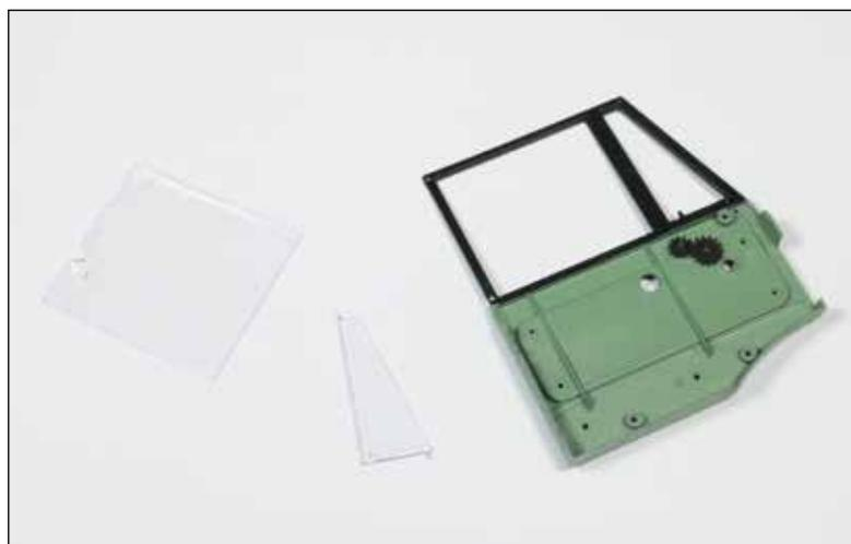
An der Türverkleidung der rechten Tür wurden zwei Zahnräder befestigt. Die beiden Fenster werden erst mit der nächsten Bauanleitung benötigt.
