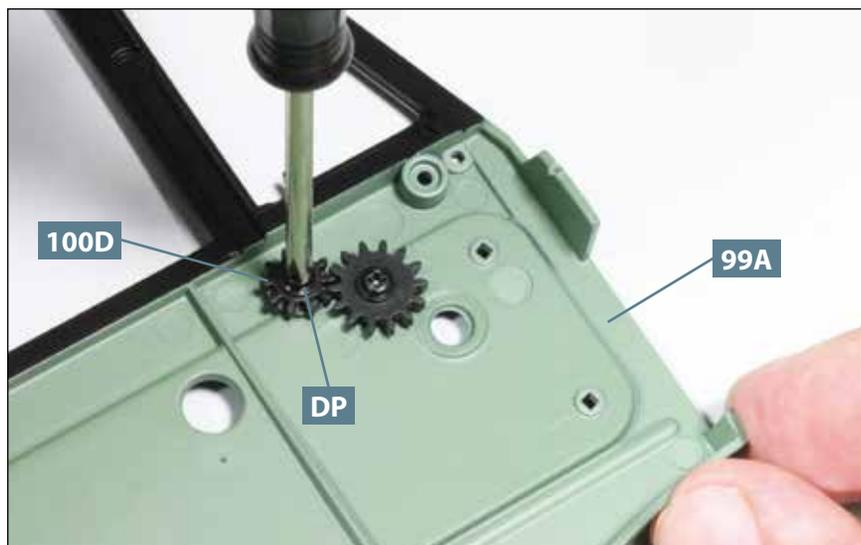
**05** Befestigen Sie das Zahnrad **100D** mit der Schraube **DP** an der Türverkleidung **99A**. Auch dieses Zahnrad bleibt drehbar.
