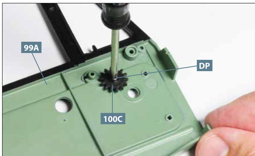
**03** Befestigen Sie das Zahnrad **100C** an der Türverkleidung **99A**, indem Sie die Schraube **DP** eindrehen. Das Zahnrad bleibt drehbar.
