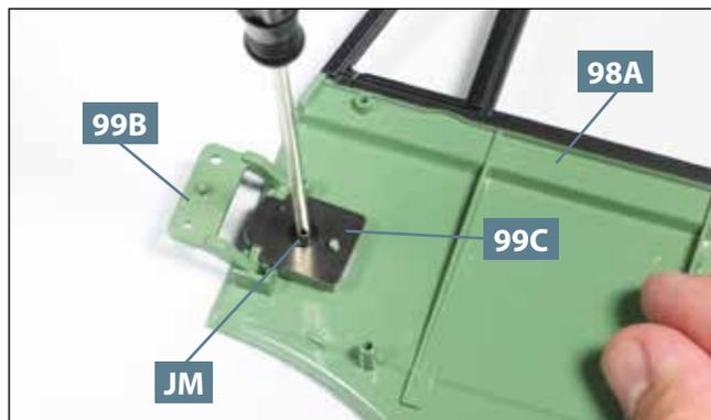
**02** Positionieren Sie die Befestigungslasche **99C** auf der Tür **98A** und über dem Türhalter **99B** und fixieren Sie sie mit der Schraube **JM**.
