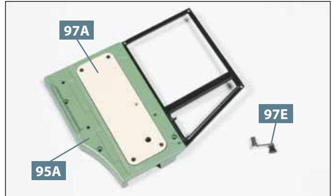
**02** Die Türpolsterung **97A** ist korrekt auf der Türverkleidung **95A** platziert. Legen Sie die Fensterkurbel **97E** bereit.
