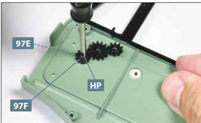
**05** Befestigen Sie das Zahnrad **97F** mit der Schraube **HP** am Schaft der Fensterkurbel **97E**. Das Zahnrad bzw. die Fensterkurbel bleibt drehbar.
