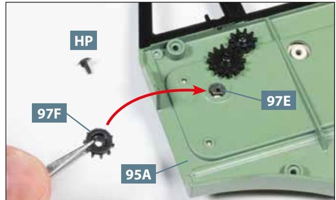
**04** Legen Sie eine Schraube **HP** bereit und drehen Sie die Türverkleidung **95A** um. Führen Sie das Zahnrad **97F** zum Schaft der Fensterkurbel **97E**. Beachten Sie, dass beide Teile eine abgeflachte Seite haben.
