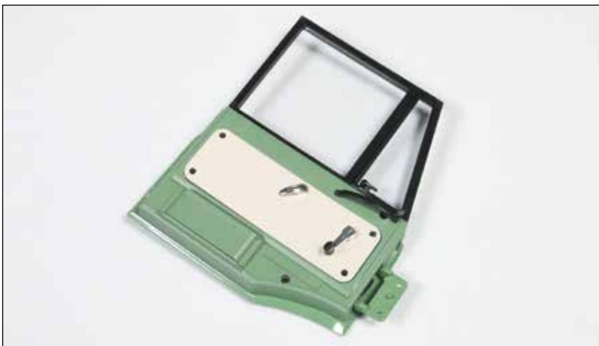
Die linke Tür ist komplettiert: Die Fenster sind eingesetzt, die Fensterkurbel ist montiert, die beiden Baugruppen wurden miteinander verbunden.
