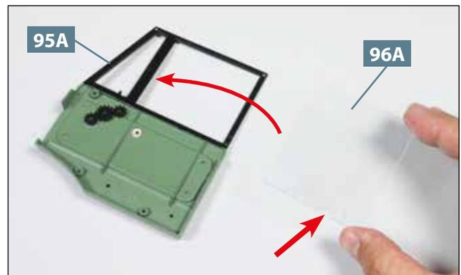
**06** Nehmen Sie die Fensterscheibe **96A**, richten Sie sie aus wie abgebildet (gerader Pfeil weist auf die halbrunde Aussparung), und führen Sie sie zur Türverkleidung **95A**.
