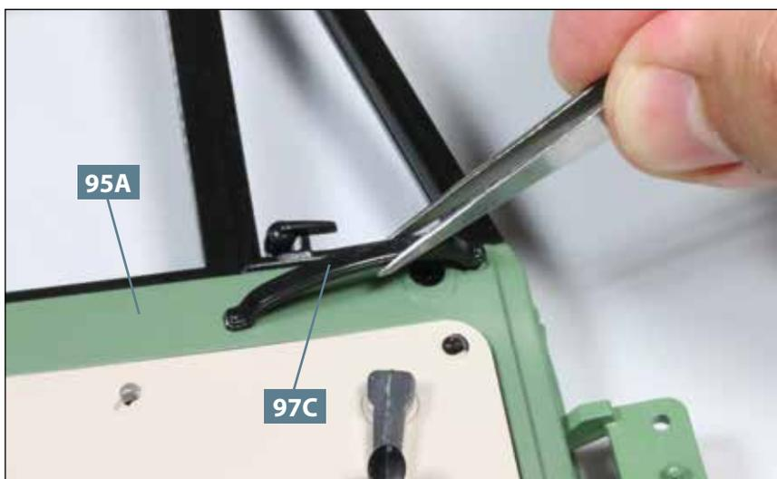
**03** Drehen Sie die Tür erneut um. Nehmen Sie den Haltegriff **97C** und befestigen Sie ihn an der Türverkleidung **95A**, indem Sie seine beiden Zapfen in die entsprechenden Löcher hineindrücken.
