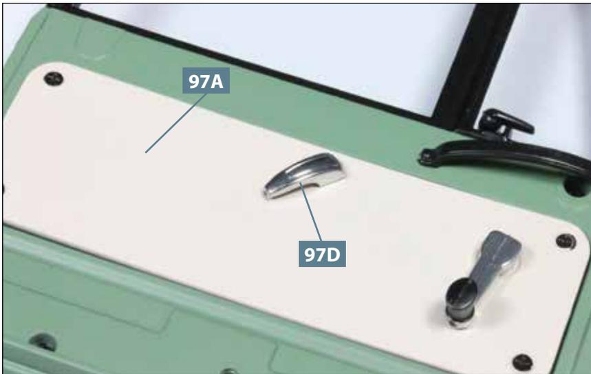
**04** Der Innendrücker **97D** wird an der Türpolsterung **97A** befestigt: Drücken Sie dazu seinen Zapfen in die Bohrung der Polsterung hinein.
