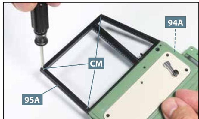
**04** Im oberen Bereich der Baugruppe wird die Türverkleidung **95A** zusätzlich mit drei Schrauben **CM** an der Tür **94A** befestigt, wie abgebildet.
