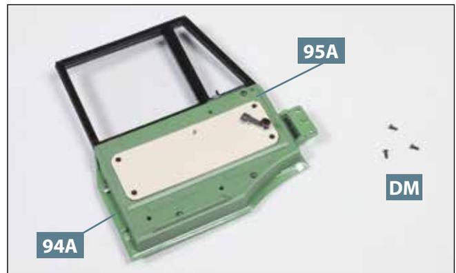
**02** Drehen Sie die zusammengefügte Baugruppe um, sodass sich die Türverkleidung **95A** über der Tür **94A** befindet. Legen Sie drei Schrauben **DM** bereit.
