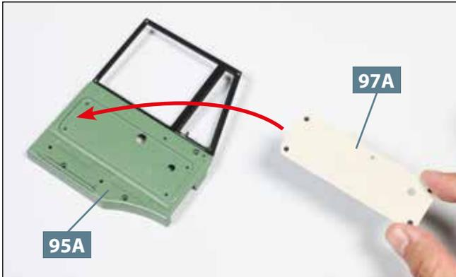
**01** Legen Sie die Türverkleidung **95A** mit der Innenseite nach oben auf Ihre Arbeitsplatte. Nehmen Sie die Türpolsterung **97A** und führen Sie sie zur Türverkleidung.
