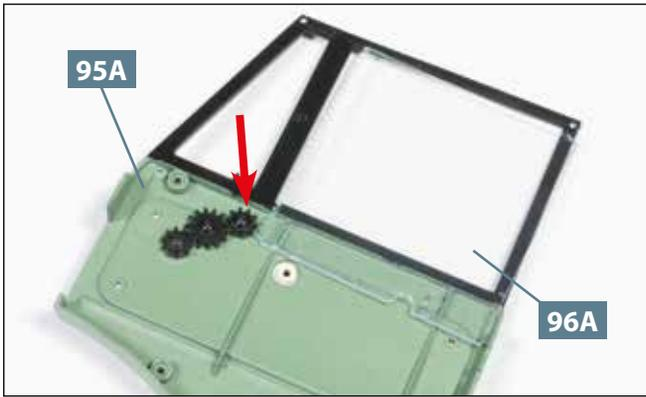
**07** Die Fensterscheibe **96A** ist korrekt auf der Türverkleidung **95A** platziert: Die Zähne am linken Fensterrand greifen in die Zähne des Zahnrads, auf das der Pfeil weist.
