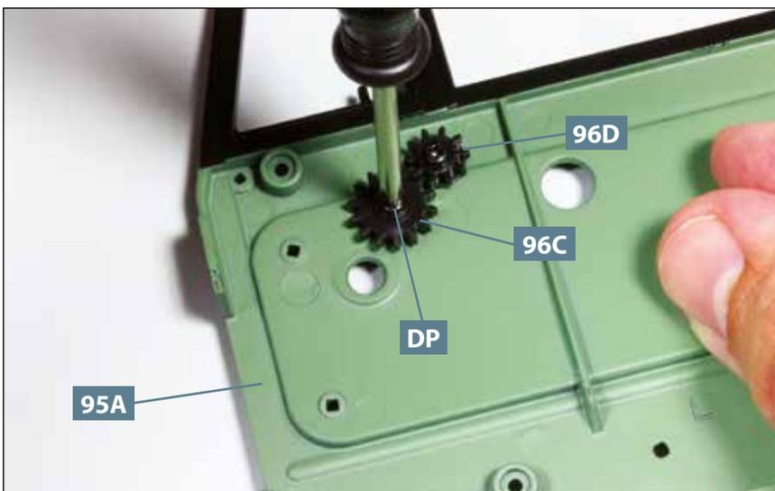
**05** Befestigen Sie das Zahnrad **96C** mit der Schraube **DP** an der Türverkleidung **95A**. Auch dieses Zahnrad bleibt drehbar. Seine Zähne greifen in die des Zahnrads **96D**, wie abgebildet.
