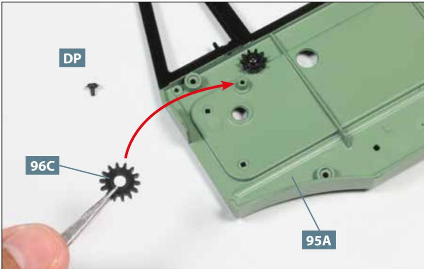
**04** Legen Sie eine weitere Schraube **DP** bereit. Nehmen Sie das Zahnrad **96C** und führen Sie es zu dem Zapfen der Türverkleidung **95A**, auf den der Pfeil weist.
