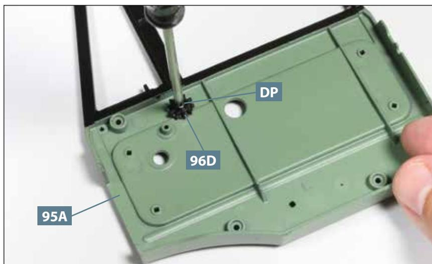
**03** Befestigen Sie das Zahnrad **96D** an der Türverkleidung **95A**, indem Sie die Schraube **DP** eindrehen. Das Zahnrad bleibt drehbar.
