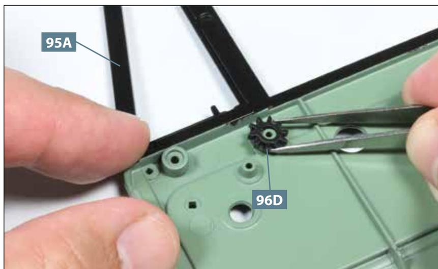
**02** Nehmen Sie das Zahnrad **96D** und platzieren Sie es auf dem abgebildeten Zapfen der Türverkleidung **95A**.
