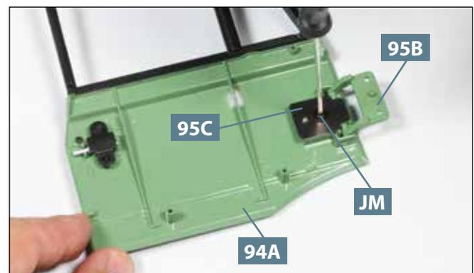
**02** Platzieren Sie die Befestigungslasche **95C** auf der Tür **94A** und über dem Türhalter **95B** und fixieren Sie sie mit einer Schraube **JM**.
