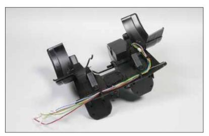
An der Unterseite des Kabinenbodens wurden zwei Stützwinkel und drei Kabelführungen angebracht.
