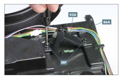
**07** Befestigen Sie den Stützwinkel **93A** mit zwei Schrauben **MP** am Kabinenboden **86A**, wie abgebildet.
