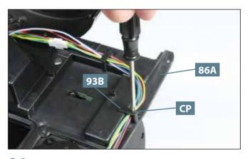
Führen Sie den Kabelstrang an der Hinterseite des Kabinenbodens **86A** entlang nach rechts und befestigen Sie über den Kabeln mit einer weiteren Schraube **CP** die nächste Kabelführung **93B**, wie abgebildet.
