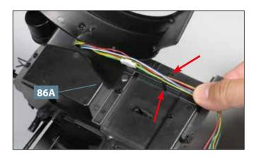
Nehmen Sie den Kabelstrang und führen Sie ihn auf der linken Seite des Kabinenbodens **86A** zwischen den beiden Aufnahmen hindurch, auf die die beiden Pfeile weisen.
