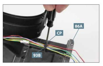
Setzen Sie die erste Kabelführung **93B** auf die beiden Aufnahmen des Kabinenbodens **86A** und fixieren Sie sie in der äußeren Aufnahme mit einer Schraube **CP**.
