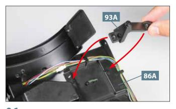
Nehmen Sie den ersten Stützwinkel 93A und führen Sie ihn zu den beiden Aufnahmen an der Unterseite des Kabinenbodens 86A, auf die die zwei Pfeile weisen.
