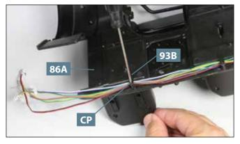
Führen Sie den Kabelstrang an der Hinterseite des Kabinenbodens **86A** ganz nach rechts und befestigen Sie über den Kabeln die letzte Kabelführung **93B** mit einer weiteren Schraube **CP**, wie es das Foto zeigt.
