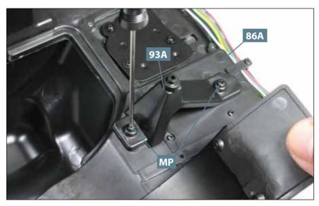
**08** Der zweite Stützwinkel **93A** wird ebenfalls mit zwei Schrauben **MP** an der Unterseite des Kabinenbodens **86A** fixiert – unweit des rechten Kotflügels.
