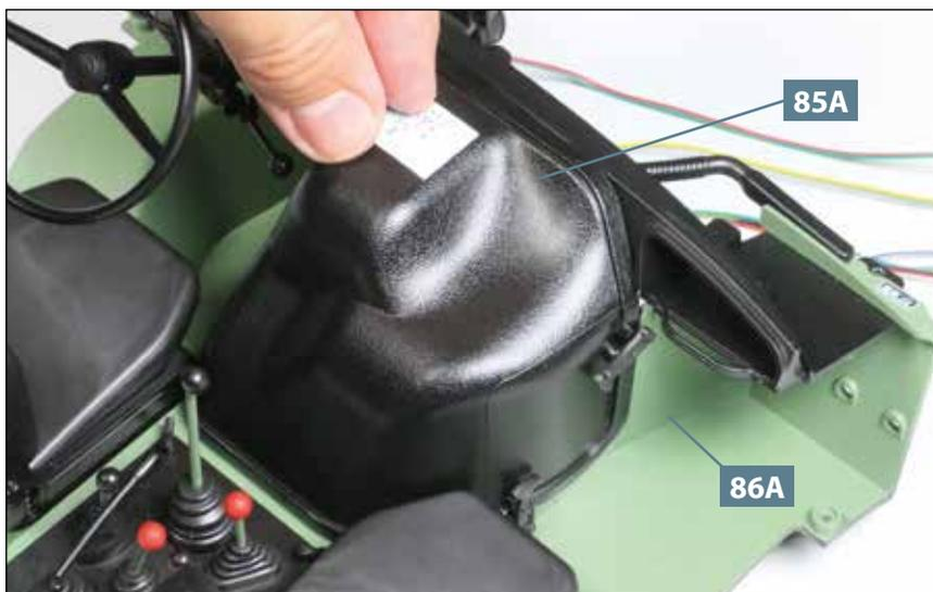
**05** Nehmen Sie die Motorabdeckung **85A** und befestigen Sie sie am Kabinenboden **86A**. Drücken Sie dazu die vier Zapfen der Abdeckung in die vier entsprechenden Löcher des Kabinenbodens hinein.
