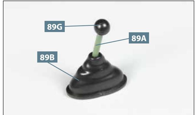
**02** Der Schalthebel **89A** ist bis zum Anschlag durch die Manschette **89B** durchgeschoben. Nehmen Sie den Knauf **89G** und befestigen Sie ihn an der Spitze des Hebels.
