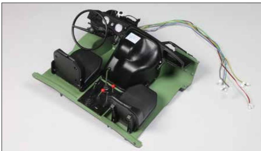
Die Schalthebelabdeckung ist komplettiert und am Kabinenboden befestigt. Die Armaturenbrett-Baugruppe und die Kabinenboden-Baugruppe sind miteinander verbunden.
