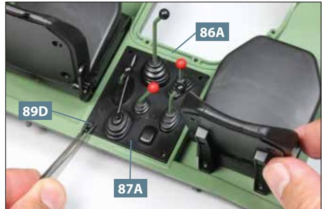
**08** Die Schalthebelabdeckung **87A** ist in der Aussparung des Kabinenbodens **86A** platziert. Nehmen Sie die erste Schnalle **89D** und fügen Sie sie in die Bohrung der Abdeckung und des Kabinenbodens ein, wie abgebildet.
