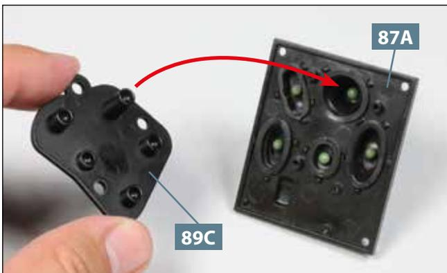
**05** Legen Sie die Schalthebelabdeckung **87A** auf die Seite. Nehmen Sie die Halterung **89C** und platzieren Sie sie so auf der Unterseite der Abdeckung, dass ihre fünf Aufnahmen die kugelförmigen Enden der Hebel umfassen.
