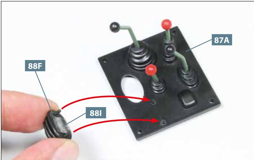
**07** Nehmen Sie die Manschette **88F** und befestigen Sie an ihrer Unterseite das doppelseitige Klebeband **88I**. Lösen Sie auch den zweiten Trägerpapier vom Klebeband. Fügen Sie anschließend die Zapfen der Manschette in die erweiterten Bohrungen der Schalthebelabdeckung **87A** ein, wie es die beiden Pfeile andeuten.
