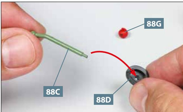
**03** Legen Sie den Knauf **88G** bereit. Nehmen Sie den Vorschaltgetriebe-Schalthebel **88C** und führen Sie dessen schmales Ende von unten durch die Öffnung der Manschette **88D**.
