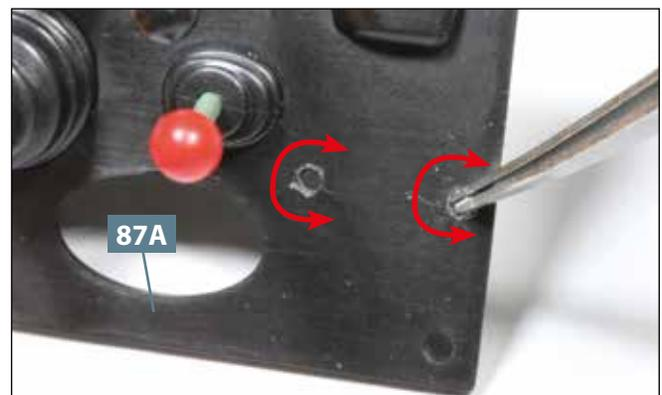
**06** Weiten Sie mithilfe einer Pinzette die beiden rechteckigen Löcher in der Schalthebelabdeckung **87A**: Sie sollen kreisförmig werden, um die Zapfen von **88F** aufzunehmen.
