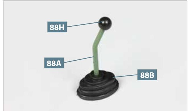
**02** Der Schalthebel **88A** ist bis zum Anschlag durch die Manschette **88B** durchgeschoben. Nehmen Sie den Knauf **88H** und befestigen Sie ihn an der Spitze des Hebels.
