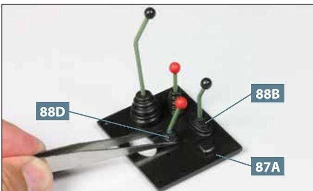
**05** Nehmen Sie die Schalthebelabdeckung **87A** zur Hand. Führen Sie die Manschette **88B** und die Manschette **88D** von unten durch die Aussparungen der Abdeckung.
