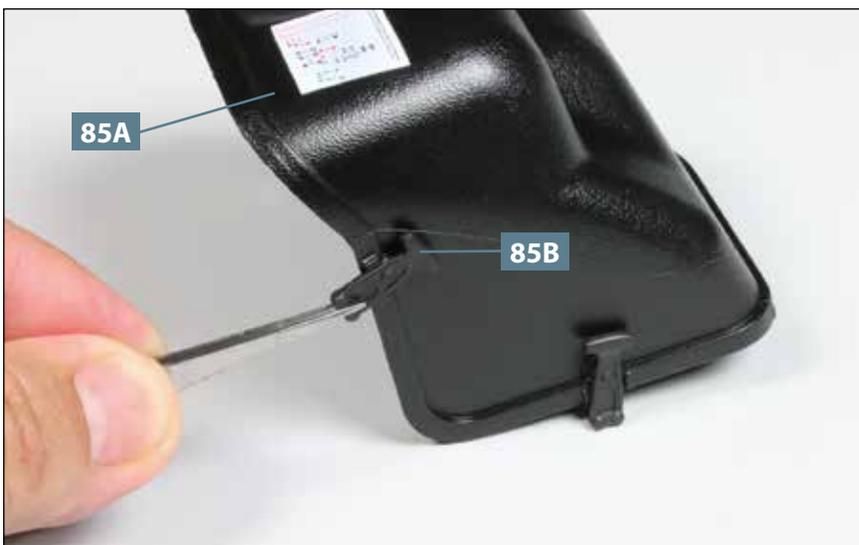
**05** Der letzte Halter **85B** gehört in die letzte freie Bohrung auf der linken Seite der Motorabdeckung **85A**, wie abgebildet.
