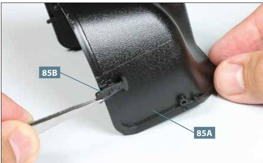
**02** Befestigen Sie den Halter **85B** an der Motorabdeckung **85A**, indem Sie seinen Zapfen in die Aufnahme hineindrücken.
