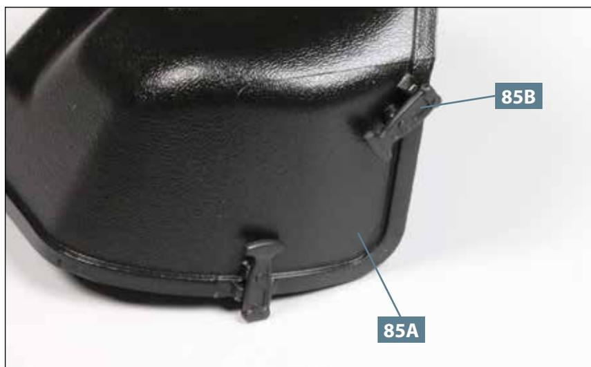
**03** In der zweiten Aufnahme auf der rechten Seite der Motorabdeckung **85A** wird der zweite Halter **85B** befestigt, wie es das Foto zeigt.
