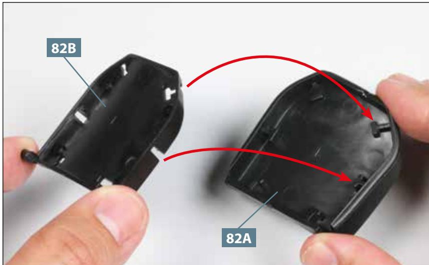
**01** Nehmen Sie die Rückenlehne **82B** und fügen Sie sie mit dem Rückenlehnenpolster **82A** zusammen, wie angedeutet. Zur Befestigung werden die sechs T-förmigen Zapfen an der Rückseite des Polsters durch die entsprechenden Schlitze der Rückenlehne geführt.
