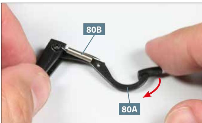
**05** Führen Sie einen Funktionstest der Feder **80B** durch, indem Sie das Kupplungspedal **80A** leicht nach unten drücken, wie es der Pfeil andeutet.
