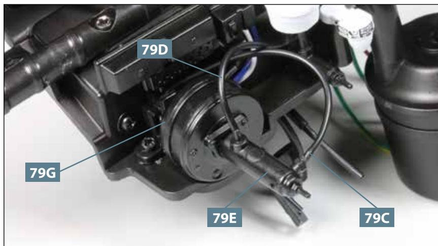
**02** Nehmen Sie den Bremsverstärker **79G** und fügen Sie dessen zwei Zapfen in die beiden Bohrungen der Vorderwand **78E** ein (Pfeile im Detailbild). Befestigen Sie die freien Enden der Leitungen **79C** und **79D** an den Zapfen des Hauptzylinders **79E**, wie es das Foto zeigt.
