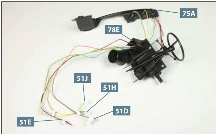
**03** Führen Sie die drei Kabel **51D**, **51E** und **51H**, deren eines Ende sich am Armaturenbrett **75A** befindet, nun ebenfalls durch die Öffnung in der Vorderwand **78E** und durch den Heizkörper **78C**, sodass ihre Stecker-Enden sich neben dem Stecker von **51J** befinden, wie es das Foto zeigt.
