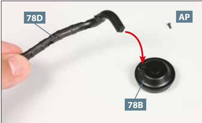
**01** Legen Sie den oberen Teil vom Luftfilter **78B** und eine Schraube **AP** bereit. Nehmen Sie den Ansaugschlauch **78D** und führen Sie seinen Zapfen zur Aufnahme am Luftfilter.
