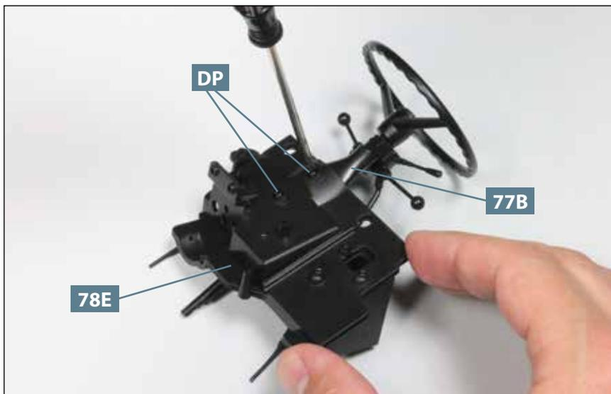
**08** Befestigen Sie die Vorderwand **78E** mit den beiden Schrauben **DP** am Lenksäulenhalter **77B**, wie abgebildet.
