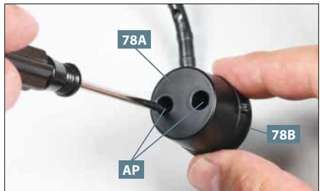
**04** Fixieren Sie die beiden Teile vom Luftfilter **78A** und **78B** aneinander, indem Sie in die Bohrungen an der Unterseite des Unterteils zwei Schrauben **AP** eindrehen.
