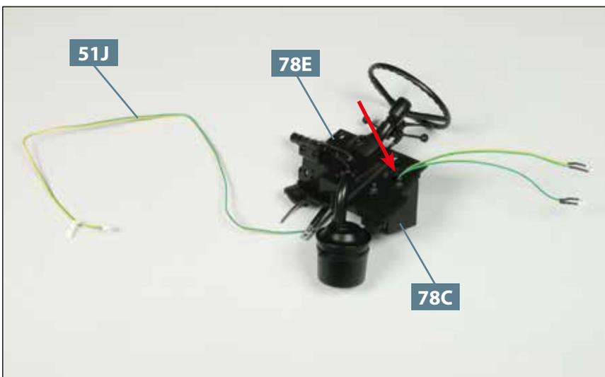
**01** Nehmen Sie das Kabel **51J** und führen Sie deren Enden mit den beiden Armaturenlichtern durch die Öffnung des Heizkörpers **78C**, sodass sie aus der rechteckigen Öffnung der Vorderwand **78E** (Pfeil) wieder herauskommen.
