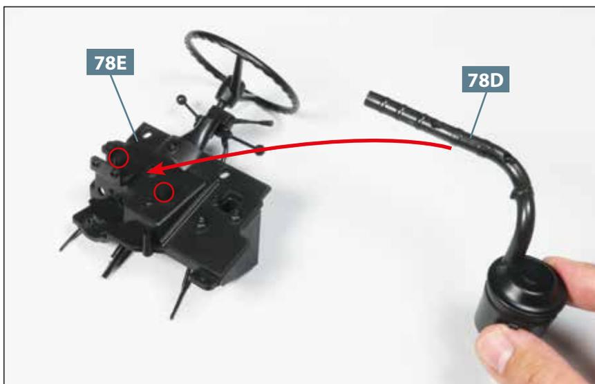
**09** Nehmen Sie die Luftfilter-Baugruppe und führen Sie den Ansaugschlauch **78D** zur Rückseite der Vorderwand **78E**. Einkreist sind die beiden Aufnahmen, an denen der Ansaugschlauch befestigt werden soll.
