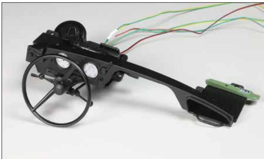
Der Luftfilter und die Lenkrad-Baugruppe sind mit der Vorderwand verbunden. Diese wurde mit dem Armaturenbrett zusammengefügt. Vier Kabel wurden verlegt.
