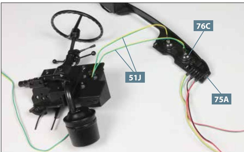
**02** Legen Sie das Armaturenbrett **75A** verkehrt herum auf Ihre Arbeitsplatte. Nehmen Sie die beiden Armaturenlichter **51J** und fügen Sie je eins in die Bohrungen an der Rückseite der Instrumententafel **76C** ein, wie abgebildet.
