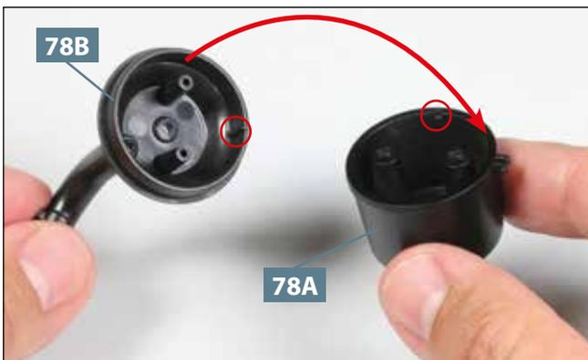
**03** Setzen Sie das Oberteil vom Luftfilter **78B** auf das Unterteil **78A**, wie angedeutet. Der Zapfen von **78B** gehört in die Nut von **78A**, beides eingekreist.
