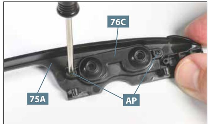
**04** Befestigen Sie die Instrumententafel **76C** mit den beiden Schrauben **AP** am Armaturenbrett **75A**.
