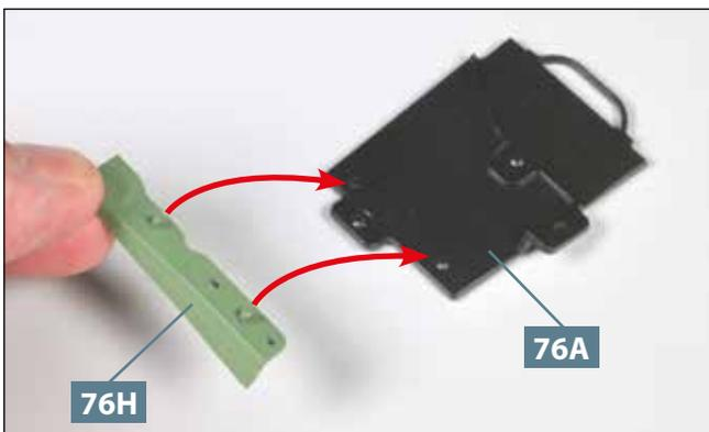
**05** Legen Sie das Kasten-Bodenteil **76A** auf Ihre Arbeitsplatte. Nehmen Sie die Abdeckung **76H** und drücken Sie ihre beiden Zapfen in die entsprechenden Bohrungen von Teil **76A** hinein, wie es die beiden Pfeile andeuten.
