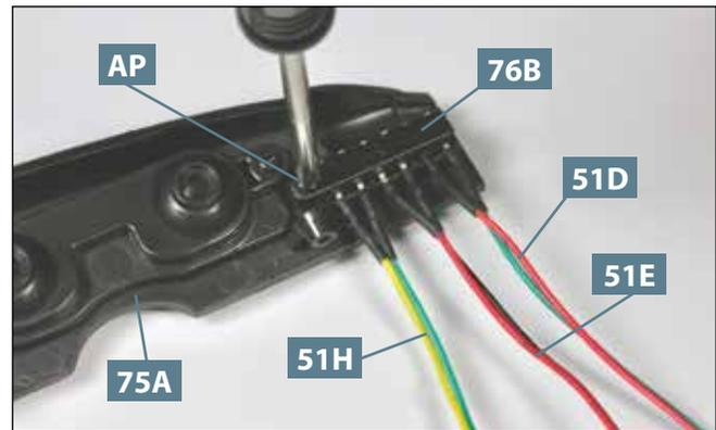
**10** Sind die Schalter der drei Kabel **51H**, **51E** und **51D** korrekt platziert, setzen Sie die Halteschiene **76B** auf und fixieren Sie sie mit einer Schraube **AP** am Armaturenbrett **75A**.
