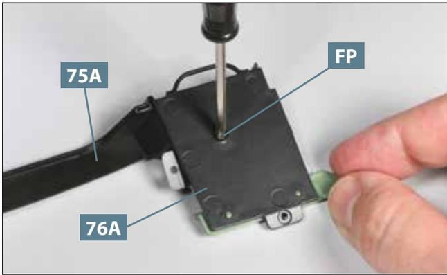
**07** Drehen Sie die gesamte Baugruppe um und befestigen Sie das Kasten-Bodenteil **76A** mit einer Schraube **FP** am Armaturenbrett **75A**, wie abgebildet.
