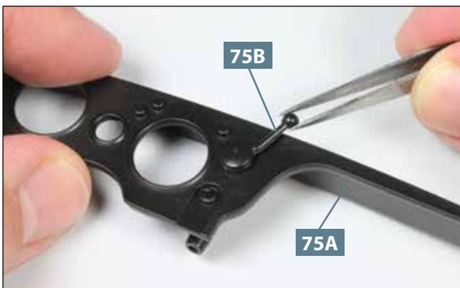
**01** Legen Sie das Armaturenbrett **75A** auf Ihre Arbeitsplatte. Nehmen Sie den Hebel **75B** und fügen Sie dessen Zapfen in die Bohrung des Armaturenbretts ein, wie abgebildet.
