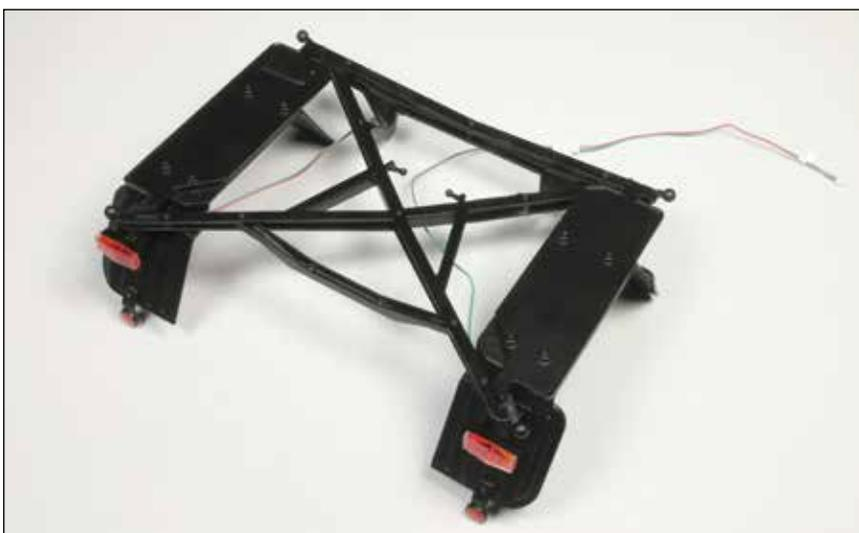
Die Schlussleuchten und die Rückstrahler sind an den hinteren Kotflügeln angebracht. Zwei LEDs wurden platziert, die Kotflügel mit dem zweiten Hilfsrahmen verbunden.
