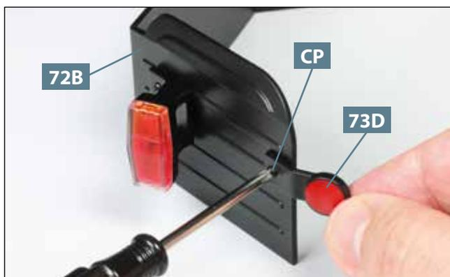
**02** Der zweite Rückstrahler **73D** wird mit einer Schraube **CP** am rechten hinteren Kotflügel **72B** fixiert.
