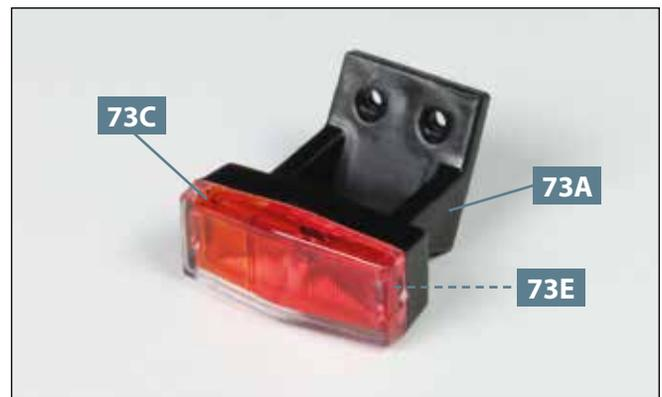
**04** Die linke Schlussleuchte **73E** ist an der linken Halterung **73A** angebracht. Achten Sie auf die Ausrichtung der Lichtscheibe **73C**: Der orangene Bereich befindet sich links.
