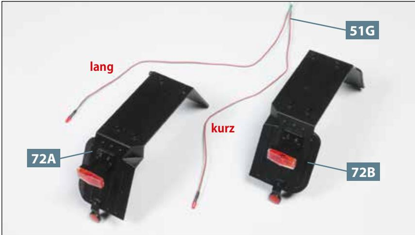
**01** Positionieren Sie die Kotflügel **72A** und **72B** so auf Ihrer Arbeitsplatte, wie abgebildet. Nehmen Sie das Kabel mit den beiden Bremslichtern **51G** und richten Sie es so aus, dass sich das etwas längere Kabel links befindet, wie es das Foto zeigt.
