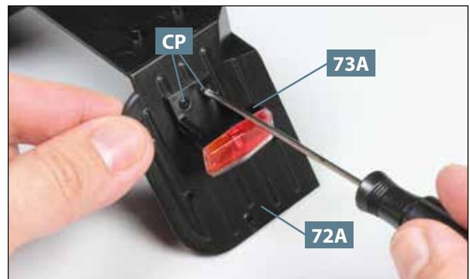
**06** Befestigen Sie die linke Halterung **73A** mit den beiden Schrauben **CP** am hinteren linken Kotflügel **72A**.
