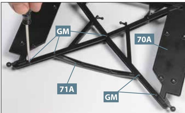
**03** Im hinteren Bereich werden die beiden Hilfsrahmen **70A** und **71A** mit den übrigen fünf Schrauben **GM** aneinander befestigt, wie abgebildet.
