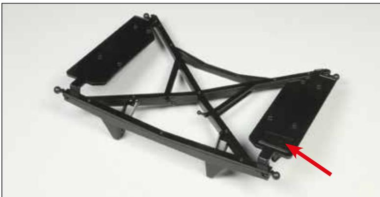
Ober- und Unterteil des zweiten Hilfsrahmens sind aneinander fixiert. Der Hemmschuh ist in die Aussparung des Rahmens eingesetzt: Der Pfeil weist auf die Stelle.
