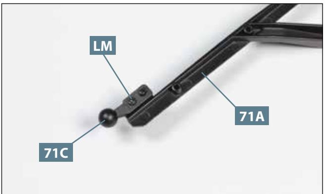
**06** Der zweite Kugelzapfen **71C** wird mit einer Schraube **LM** am hinteren rechten Ende des Hilfsrahmens **71A** befestigt, wie es das Foto zeigt.
