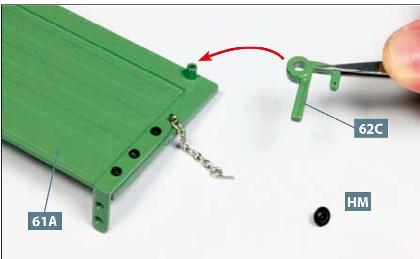
**03** Wechsel ans andere Ende der Vorderwand **61A**. Nehmen Sie den rechten Kastenverschluss **62C** und platzieren Sie dessen Öse über dem Zapfen der Vorderwand, wie es der Pfeil andeutet. Legen Sie eine weitere Schraube **HM** bereit.
