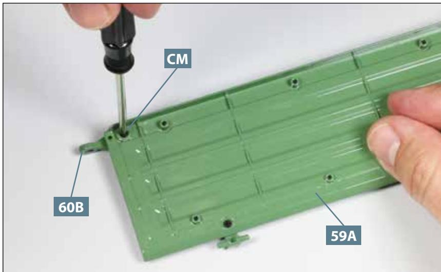
**04** Halten Sie die Verriegelungsöse **60B** in Position und drehen Sie die Seitenwand **59A** erneut um. Befestigen Sie die Verriegelungsöse mit einer Schraube **CM** an der Seitenwand, wie abgebildet.
