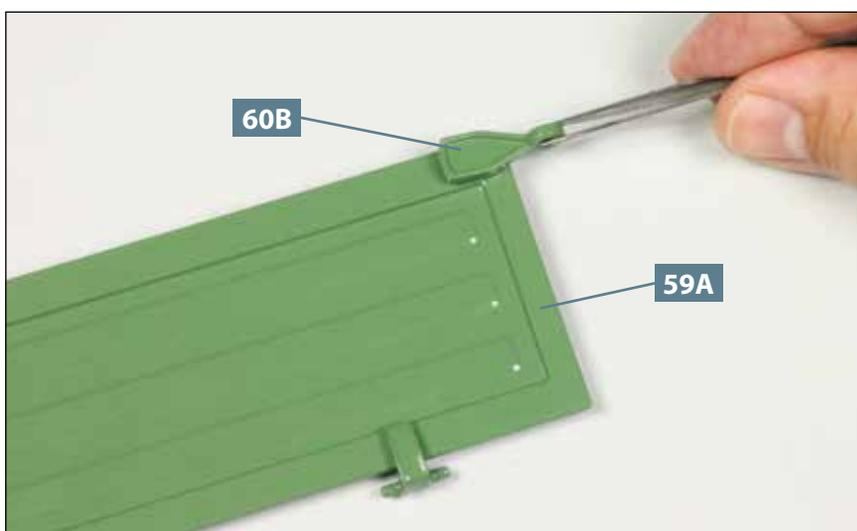
**03** Drehen Sie die Seitenwand **59A** wieder um. Platzieren Sie die zweite Verriegelungsöse **60B** in den Vertiefungen am anderen Ende der Seitenwand, wie es das Foto zeigt.
