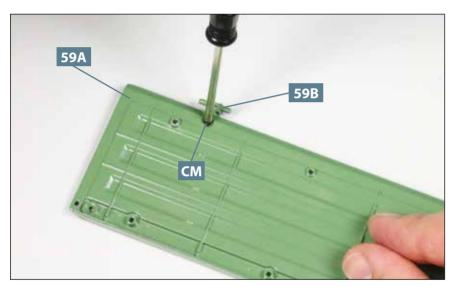
**05** Halten Sie das Scharnier **59B** in Position während Sie die Seitenwand **59A** umdrehen. Fixieren Sie das Scharnier an der Seitenwand, indem Sie die Schraube **CM** festziehen.
