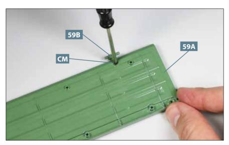
O3 Halten Sie das Scharnier 59B in Position, während Sie die Seitenwand 59A umdrehen. Befestigen Sie das Scharnier mit der Schraube CM an der Seitenwand.
