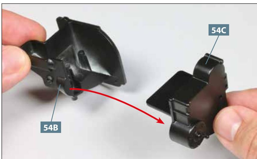
**03** Nehmen Sie das Gehäuse mit Achse **54B** und fügen Sie es mit dem Reglergehäuse **54C** zusammen, wie angedeutet.
