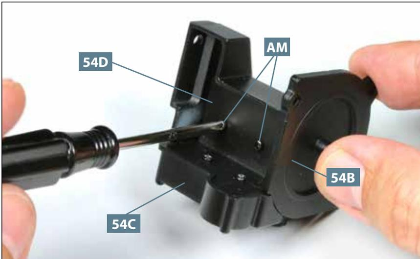
**04** Fixieren Sie die beiden Gehäuseteile **54B** und **54C** aneinander, indem Sie in die freien Bohrungen der Halterung **54D** zwei Schrauben **AM** eindrehen.
