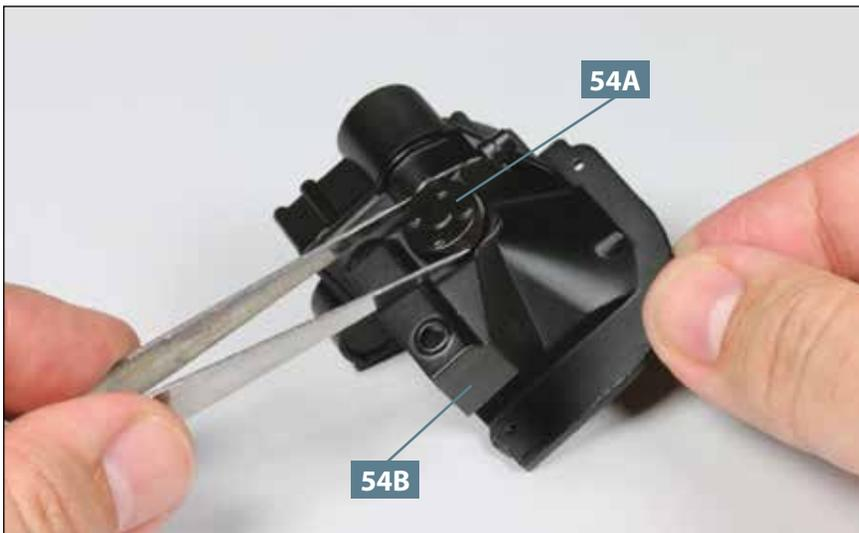
**05** Setzen Sie den Flansch **54A** auf den Zapfen am Gehäuseteil **54B**. Es handelt sich um eine Steckverbindung.
