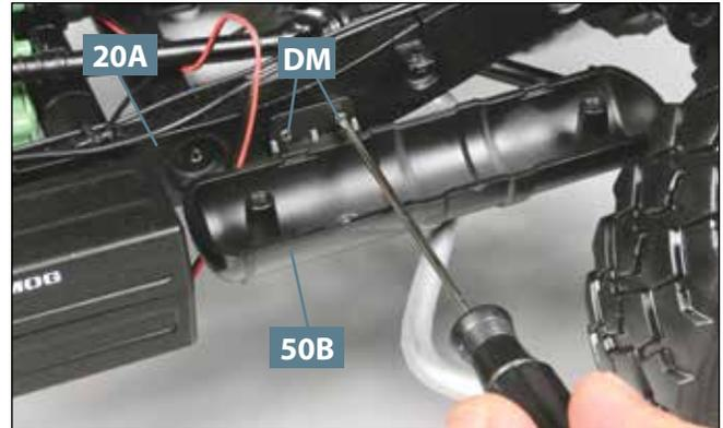
**02** Fixieren Sie das Unterteil vom Druckluftbehälter **50B** mit zwei Schrauben **DM** am linken hinteren Längsträger **20A**.
