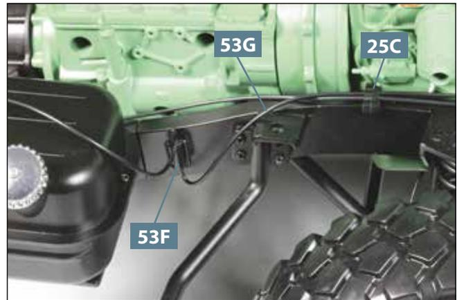
**10** Befestigen Sie die Kraftstoffleitung **53G** am unteren Zapfen des Kraftstofffilters **53F**. Die Leitung wird durch die zweitinnerste Aufnahme der Führung **25C** nach vorne geführt.
