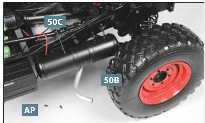
**04** Das Foto zeigt das auf dem Unterteil **50B** platzierte Oberteil des Kraftstoffbehälters **50C**. Legen Sie zwei Schrauben **AP** bereit.
