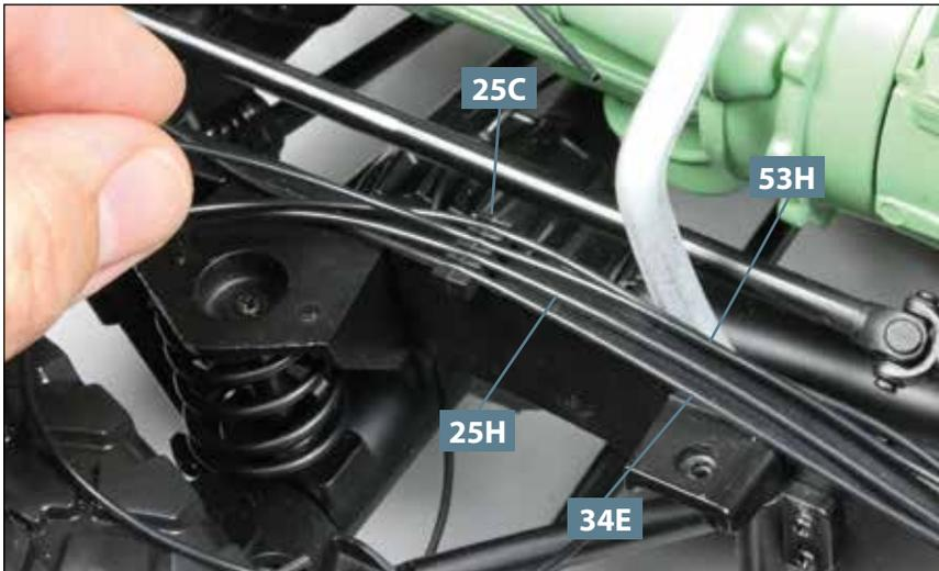
**13** Auch in der vorderen Führung **25C** werden die beiden Leitungen **25H** und **34E** um jeweils eine Aufnahme nach außen verlegt. Sie machen Platz für das mit dem letzten Bauschritt befestigte Handbremsseil **53H**, das in beiden Führungen **25C** durch die zweitinnerste Aufnahme verlaufen soll. Das vordere Ende von **53H** bleibt vorerst frei.
