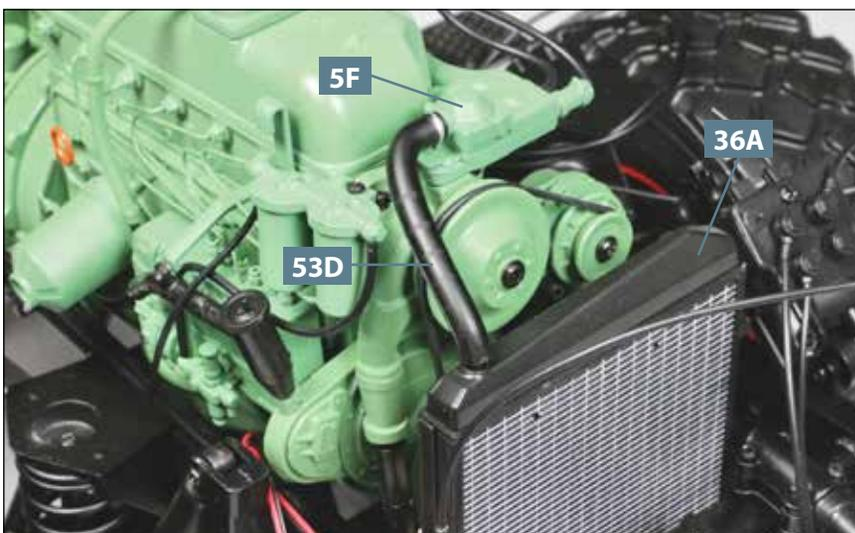
**02** Befestigen Sie die Rücklaufleitung **53D** am Kühlwasser-Thermostat **5F** und am Oberteil des Kühlers **36A**.
