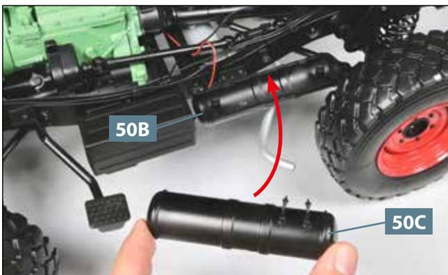
**03** Nehmen Sie das Oberteil des Kraftstoffbehälters **50C** und führen Sie es zum Unterteil **50B**, wie angedeutet.
