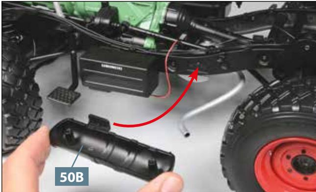
**01** Nehmen Sie das Unterteil vom Druckluftbehälter **50B** und führen Sie es zur Aufnahme auf der linken Seite des Doppelrahmens, wie angedeutet.
