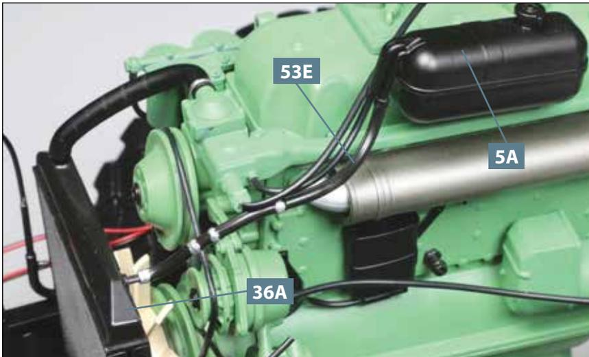
**03** Nehmen Sie die Wasserleitung 53E. Ihre Enden werden in die Aufnahmen an der Rückseite vom Oberteil des Kühlers 36A sowie am Ausgleichsbehälter 5A eingefügt, wie abgebildet.
