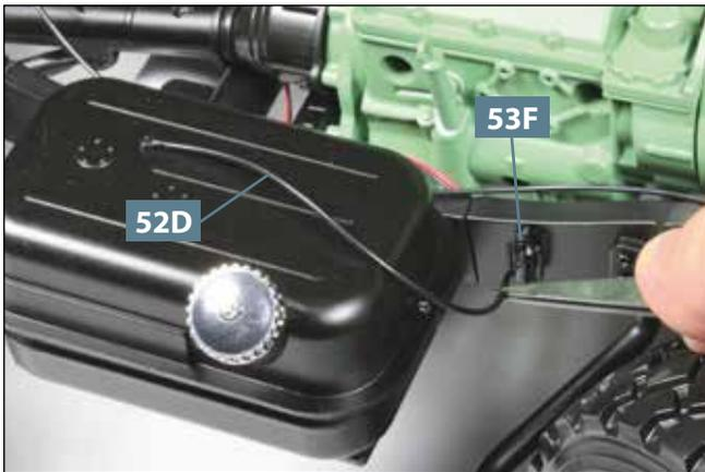
**09** Befestigen Sie das freie Ende der Leitung **52D** am seitlichen Zapfen des Kraftstofffilters **53F**, wie abgebildet.
