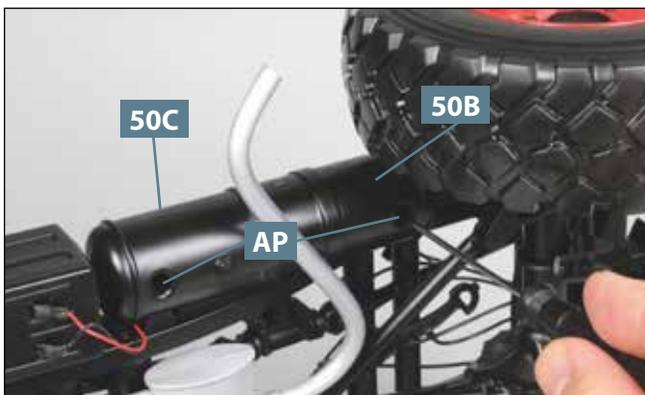
**05** Legen Sie das Modell vorsichtig auf die Seite und fixieren Sie die beiden Hälften des Kraftstoffbehälters **50B** und **50C** aneinander, indem Sie von unten die zwei Schrauben **AP** eindrehen.
