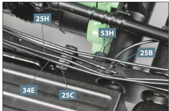
**12** Zurück auf die linke Modellseite. Verlegen Sie die Leitungen **25H** und **34E** in der Führung **25C** jeweils eine Aufnahme nach außen. Befestigen Sie das Handbremsseil **53H** am vorderen Zapfen des Bremskraftverteilers **25B**.
