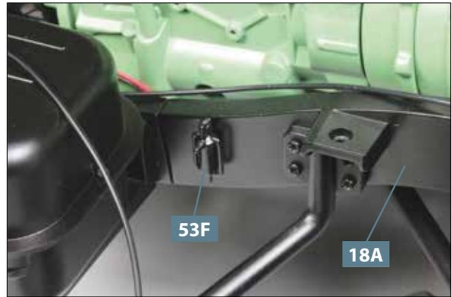
**08** Wechsel auf die rechte Seite des Modells. Befestigen Sie den Kraftstofffilter **53F** am Längsträger **18A**, indem Sie seine beiden Zapfen in die Bohrungen hineindrücken.
