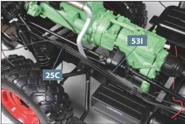
**07** Der Druckluftschlauch **53I** wird weiter nach vorne geführt und läuft an der vordersten Führung **25C** durch die innerste Aufnahme. Sein vorderes Ende bleibt vorerst frei.
