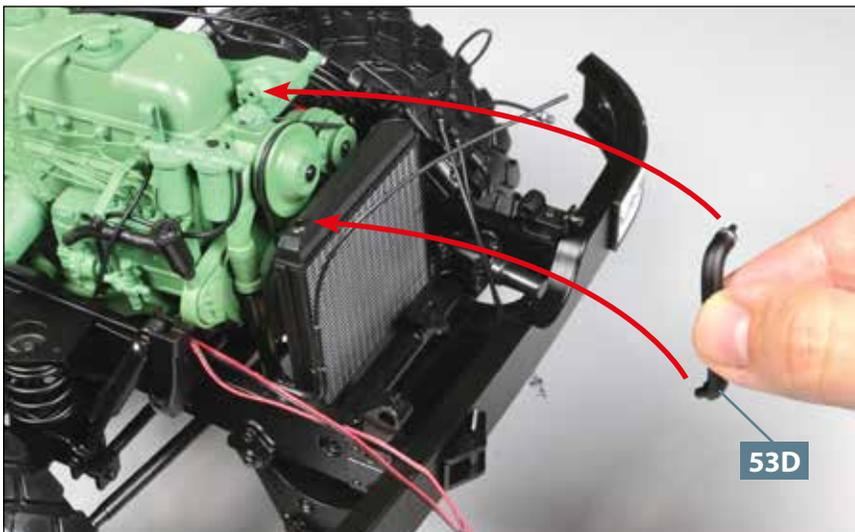
**01** Nehmen Sie die Rücklaufleitung **53D** und führen Sie sie zu den Aufnahmen am Kühler bzw. am Kühlwasser-Thermostat, wie es die Pfeile andeuten.
