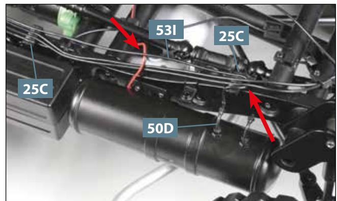
**06** Befestigen Sie den Druckluftschlauch **531** am vorderen Anschluss **50D**. Führen Sie ihn unter den anderen Leitungen hindurch, aber über dem Stromkabel (Pfeile) und drücken Sie ihn in die innerste Aufnahme der Führungen **25C** hinein.
