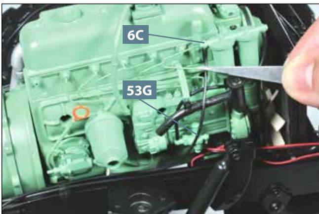
**11** Das vordere Ende der Kraftstoffleitung **53G** wird am Zapfen vom Deckel des Kraftstofffilters **6C** befestigt.
