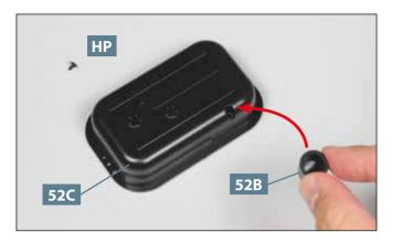
**01** Legen Sie das Oberteil des Kraftstofftanks **52C** und eine Schraube **HP** auf Ihre Arbeitsplatte. Nehmen Sie die Einfüllöffnung **52B** und führen Sie sie zur Aufnahme des Tanks.
