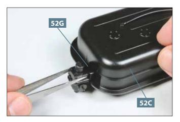
**07** Um den Vorfilter am Kraftstofftank **52C** zu befestigen, drücken Sie den Zapfen der Halterung **52G** vorsichtig in die Bohrung am Rand der Tanks.
