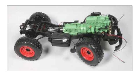
Das Oberteil des Kraftstofftanks wurde mit diversen Details versehen und anschließend am Unterteil befestigt.
