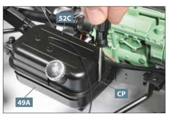
10 Fixieren Sie das Oberteil des Kraftstofftanks 52C mit einer Schraube CP am Unterteil 49A. (Die Schraubverbindung am hinteren Ende des Tanks bleibt vorerst offen.)
