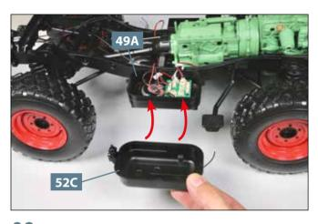
**09** Stellen Sie das Modell so auf Ihre Arbeitsplatte, dass Sie Zugriff auf dessen rechte Seite haben. Setzen Sie das Oberteil des Kraftstofftanks **52C** auf das Unterteil **49A**, wie angedeutet.
