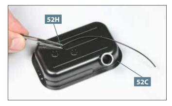
**04** Befestigen Sie den Anschluss **52H** am Oberteil des Kraftstofftanks **52C**: Drücken Sie dazu den Zapfen vorsichtig in die Bohrung des Tanks, wie abgebildet.
