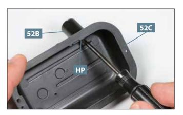
**02** Fixieren Sie die Einfüllöffnung **52B** am Oberteil des Kraftstofftanks **52C**, indem Sie an dessen Innenseite die Schraube **HP** eindrehen.
