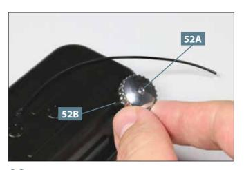
**08** Nehmen Sie den Tankverschluss **52A** und drücken Sie dessen unteren Rand in die Einfüllöffnung **52B**.
