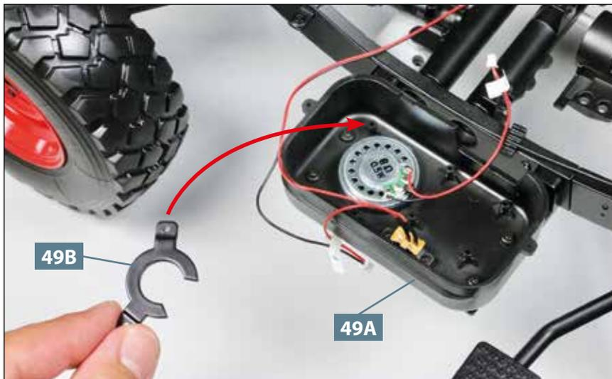
**07** Nehmen Sie die Halterung **49B** und führen Sie sie, ausgerichtet wie abgebildet, zum Unterteil des Kraftstofftanks **49A**.
