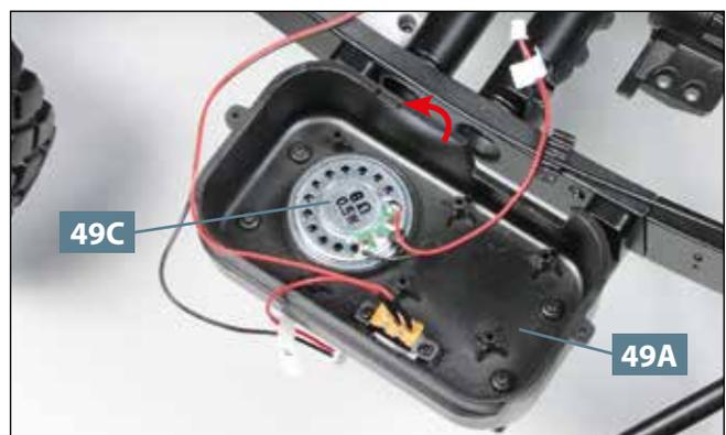
**06** Platzieren Sie den Lautsprecher **49C** in der runden Aussparung, die sich im Unterteil vom Kraftstofftank **49A** befindet, wie abgebildet.
