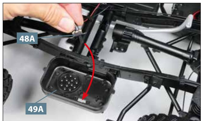
**04** Nehmen Sie den Schalter, der sich am Ende vom Kabel des Batteriefachs **48A** befindet, und führen Sie ihn durch die Öffnung im Unterteil vom Kraftstofftank **49A**, wie angedeutet.
