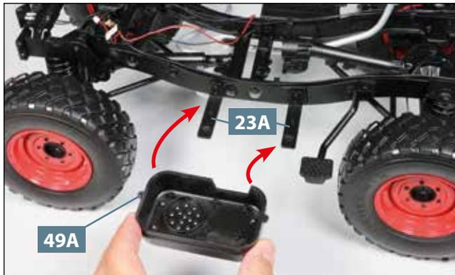
**01** Führen Sie das Unterteil vom Kraftstofftank **49A** zu den beiden Halterungen **23A**, die sich an der rechten Seite des Leiterrahmens befinden.
