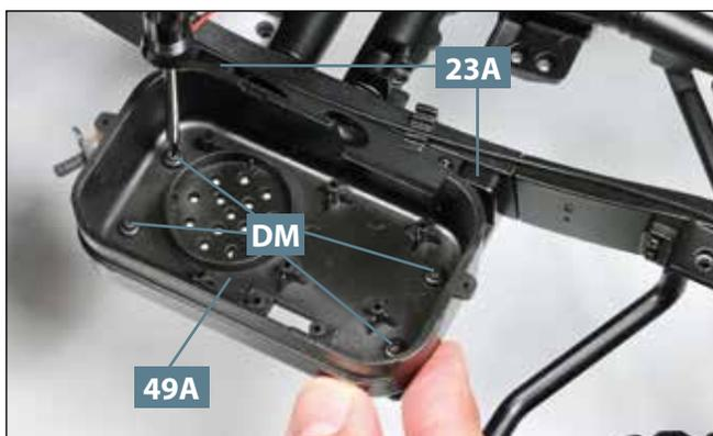
**03** Fixieren Sie das Unterteil vom Kraftstofftank **49A** mit vier Schrauben **DM** an den beiden Halterungen **23A**.
