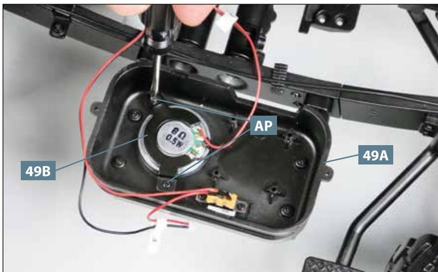
**08** Fixieren Sie die Halterung **49B** mit zwei Schrauben **AP** am Unterteil des Kraftstofftanks **49A**. Durch die Halterung wird der Lautsprecher in Position gehalten.
