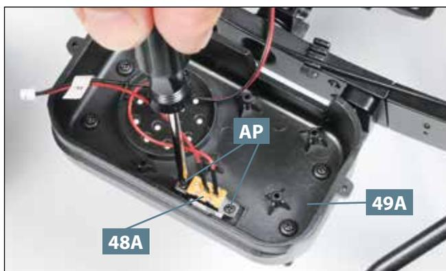
**05** Befestigen Sie den Schalter vom Kabel **48A** mit zwei Schrauben **AP** am Unterteil vom Kraftstofftank **49A**.
