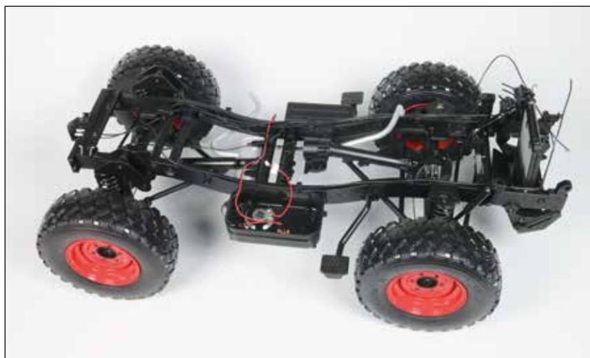
An der rechten Seite des Rahmens wurde der Kraftstofftank angebracht. Der Lautsprecher wurde im Tank befestigt.
