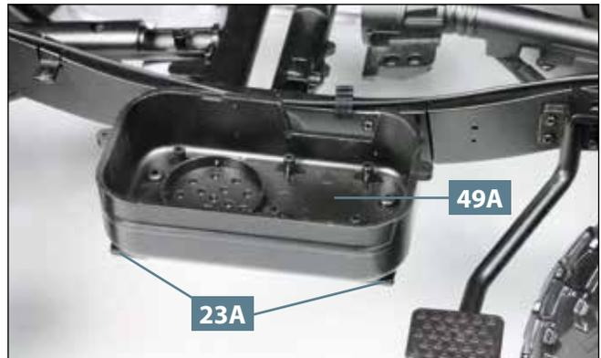
**02** Das Unterteil vom Kraftstofftank **49A** ist korrekt platziert, wenn seine vier Bohrungen auf den Aufnahmen der beiden Halterungen **23A** sitzen.
