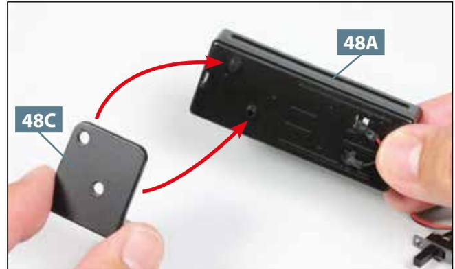
**02** Nehmen Sie die Gehäusehalterung **48C** und führen Sie sie zur Unterseite des Batteriefachs **48A**, wie es die beiden Pfeile andeuten.
