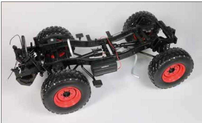
Das Batterie-fach wurde am Rahmen angebracht und mit dem Gehäuse versehen. Ein Kabel wurde auf die andere Modellseite geführt.
