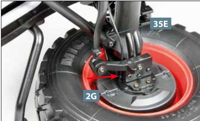
**01** Am linken Vorderrad: Nehmen Sie die Bremsleitung **35E** und stülpen Sie ihr Ende über den Zapfen am linken Achsschenkel **2G**. Der Pfeil weist auf die Stelle.
