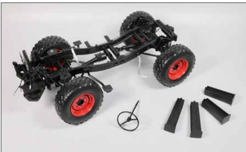
Das Modell steht auf seinen vier Rädern. Die Hydrauliksteuerung wurde montiert, die Lenksäule vorerst wieder demontiert.
