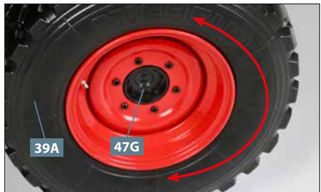
**04** Prüfen Sie, ob sich der Hinterreifen **39A** ohne Widerstand drehen lässt. Falls nicht: Lösen Sie die Schraube **BM** leicht. Setzen Sie eine Radkappe **47G** auf.
