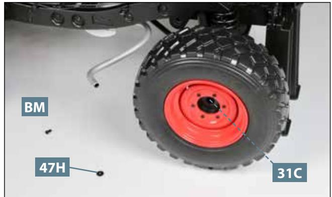
**02** Stülpen Sie die Nabe des Hinterrads über den großen Zapfen des Vorgelegegehäuses **31C**, wie abgebildet. Legen Sie eine Unterlegscheibe **47H** und eine Schraube **BM** bereit.
