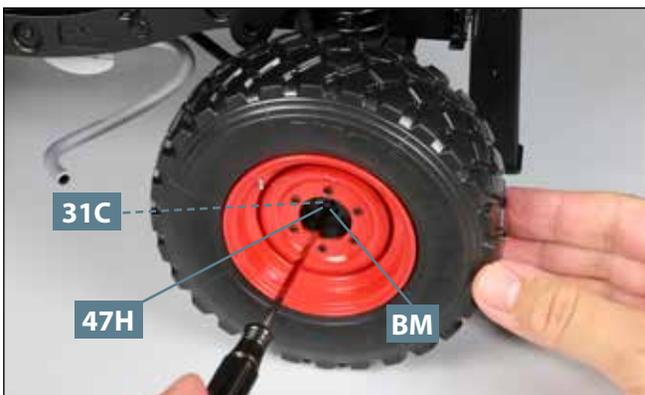
**03** Platzieren Sie die Unterlegscheibe **47H** auf dem Zapfen des Vorgelegegehäuses **31C** und ziehen Sie in dessen Bohrung die Schraube **BM** fest, wie abgebildet.
