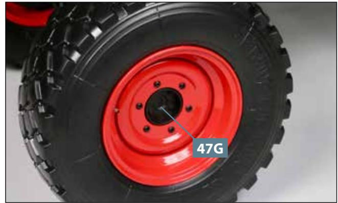
**08** Nach erfolgreichem Test des Laufverhaltens vom rechten Hinterrad wird die verbliebene Radkappe **47G** über der Nabe des Rads eingefügt.
