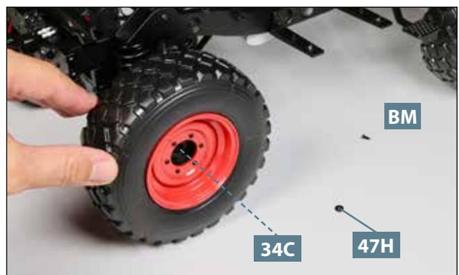
**06** Stülpen Sie die Nabe des Hinterrads über den großen Zapfen des Vorgelegegehäuses **34C**. Legen Sie eine weitere Unterlegscheibe **47H** und eine Schraube **BM** bereit.
