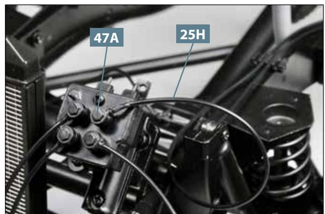
**10** Befestigen Sie das vordere Ende vom langen Hydraulikschlauch **25H** am Zapfen des „freien“ Anschlusses **47A**, wie es das Foto zeigt.
