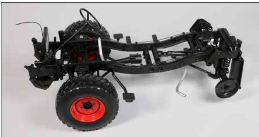
Die beiden Vorderräder sind am Modell angebracht. Die Lenkung wurde vervollständigt und auch bereits getestet.
