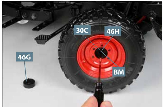
**16** Platzieren Sie die Unterlegscheibe **46H** auf dem Zapfen vom Achsschenkel **30C** und ziehen Sie in der Bohrung die Schraube **BM** fest. Legen Sie die Radkappe **46G** bereit.
