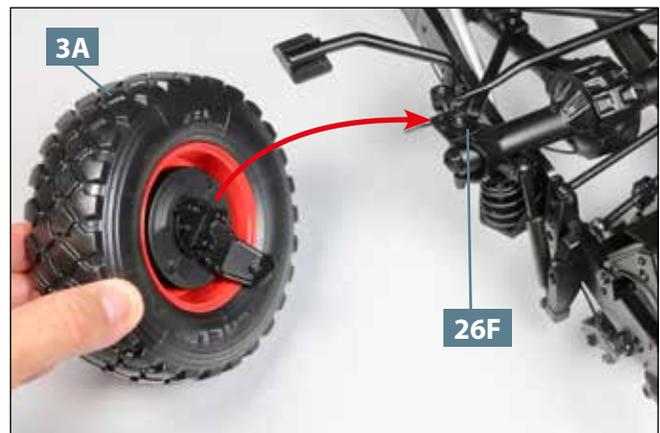
**12** Stellen Sie den Leiterrahmen auf den Kopf und führen Sie das mit der 3. Bauanleitung zusammengeführte Vorderrad **3A** zum Spurhebel **26F** am linken Ende der Vorderachse.
