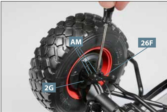
**13** Befestigen Sie den Achsschenkel **2G** mit drei Schrauben **AM** am Spurhebel **26F**, wie es das Foto zeigt.
