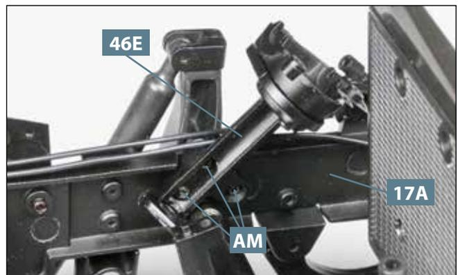
**04** Fixieren Sie die Halterung **46E** mit drei Schrauben **AM** an den Zapfen, die sich an der Innenseite des linken vorderen Längsträgers **17A** befinden.
