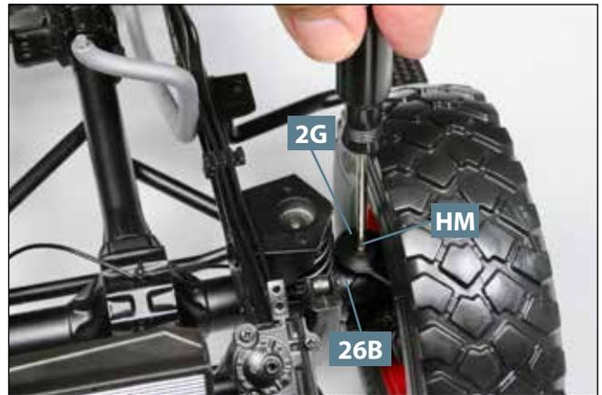
**14** Drehen Sie den Leiterraum wieder um und befestigen Sie den Achsschenkel **2G** mit einer Schraube **HM** am Zapfen der Vorderachse **26B**.
