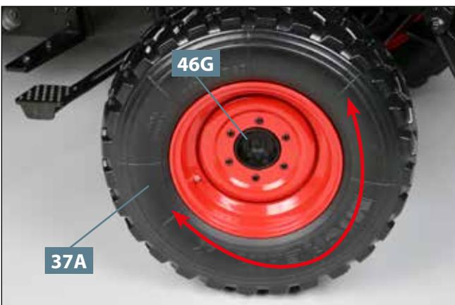
**17** Prüfen Sie, ob sich der Vorderreifen **37A** ohne Widerstand drehen lässt. Falls nicht: Lösen Sie die Schraube **BM** leicht. Setzen Sie die Radkappe **46G** auf.
