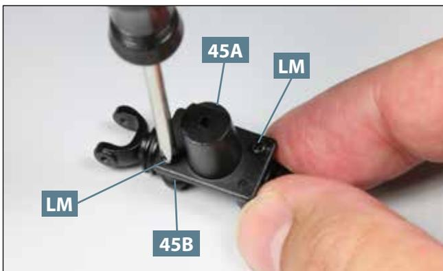
**05** Befestigen Sie die Halterung des hinteren Nebenabtriebs **45A** am Lagergehäuse **45B**, indem Sie zwei Schrauben **LM** in die abgebildeten Bohrungen eindrehen.
