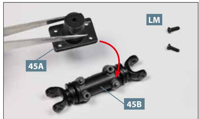
**04** Platzieren Sie die Halterung des hinteren Nebenabtriebs **45A** auf der äußeren Hälfte des Lagergehäuses **45B**, wie angedeutet. Legen Sie zwei Schrauben **LM** bereit.
