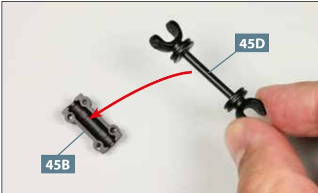
**01** Nehmen Sie die Zwischenwelle **45D** und führen Sie sie zur äußeren Hälfte des Lagergehäuses **45B**, wie angedeutet.
