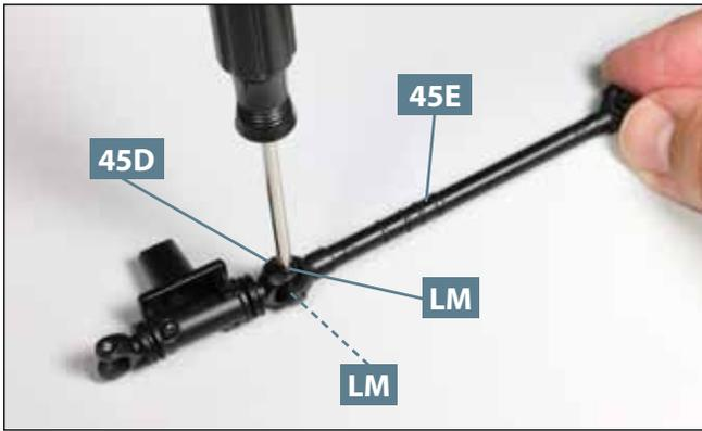
**07** Befestigen Sie die Gabel der Zwischenwelle **45D** mit zwei Schrauben **LM** am vorderen Gelenk der Welle **45E**.
