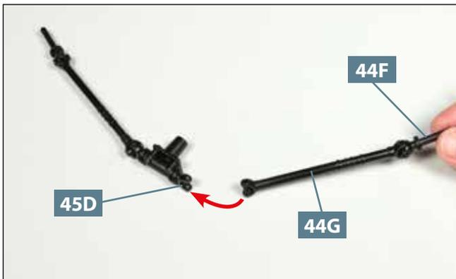
**09** Nehmen Sie die mit der 44. Bauanleitung gefertigte Baugruppe **44F/44G** und führen Sie das hintere Gelenk der Welle **44G** zur vorderen Gabel der Zwischenwelle **45D**.
