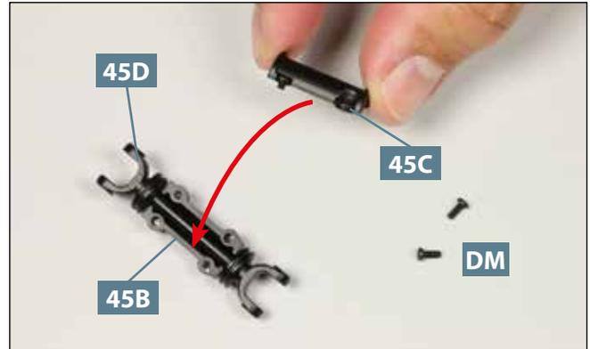
**02** Die Zwischenwelle **45D** ist im Teil **45B** platziert. Setzen Sie die innere Hälfte des Lagergehäuses **45C** auf die äußere Hälfte, wie angedeutet. Legen Sie zwei Schrauben **DM** bereit.
