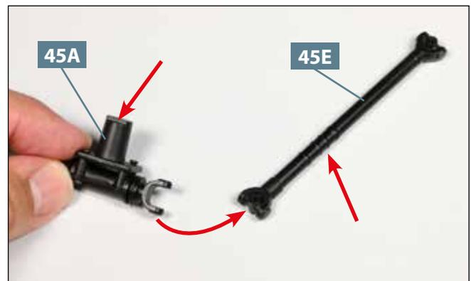
**06** Führen Sie die Halterungs-Baugruppe zur hinteren Antriebswelle **45E**. Achten Sie unbedingt auf die Ausrichtung der Halterung **45A** und der Welle **45E** (gerade Pfeile)!
