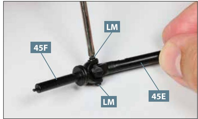
**08** Am hinteren Gelenk der Welle **45E** wird die Gabel der hinteren Antriebswelle **45F** mit zwei Schrauben **LM** befestigt, wie abgebildet.
