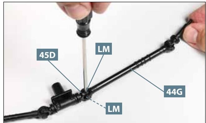
**10** Fixieren Sie die Gabel der Zwischenwelle **45D** mit zwei Schrauben **LM** am hinteren Gelenk der Welle **44G**, wie es das Foto zeigt.
