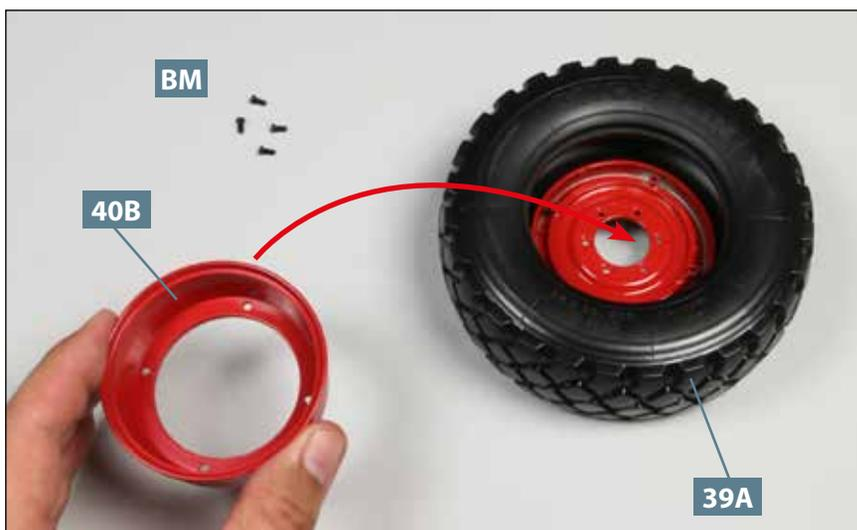
**02** Drehen Sie den Hinterreifen **39A** um. Nehmen Sie die innere Hälfte des Scheibenrads **40B** und führen Sie sie zum Reifen, wie angedeutet. Legen Sie vier Schrauben **BM** bereit.
