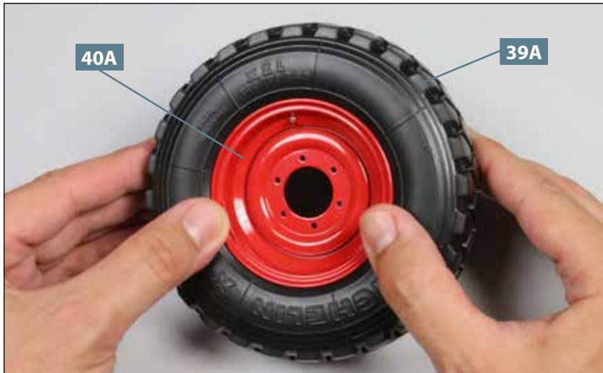
**01** Legen Sie den ersten Hinterreifen **39A** auf Ihre Arbeitsplatte. Nehmen Sie die äußere Hälfte des Scheibenrads **40A** und setzen Sie sie in den Reifen ein. Achten Sie darauf, dass das Rad überall plan am Reifen aufliegt, wie abgebildet.
