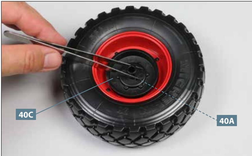
**04** Setzen Sie die Bremstrommel **40C** von innen auf die äußere Hälfte des Scheibenrads **40A**. Achten Sie dabei auf die Ausrichtung der Bremstrommel.
