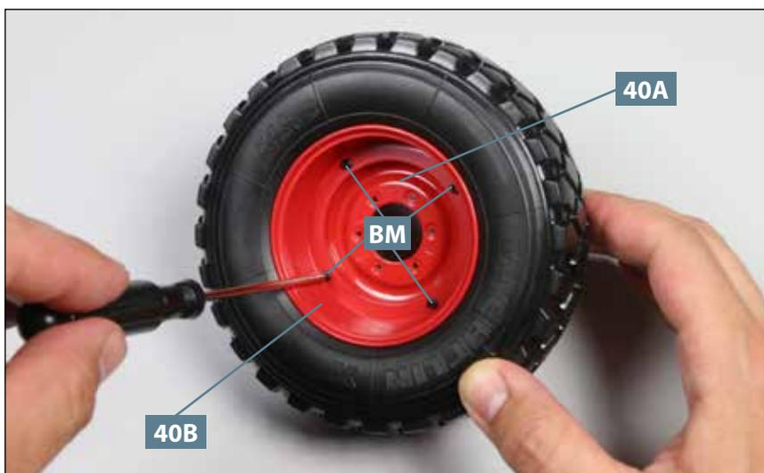
**03** Fixieren Sie die beiden Scheibenrad-Hälften **40A** und **40B** mit den vier Schrauben **BM** aneinander.
