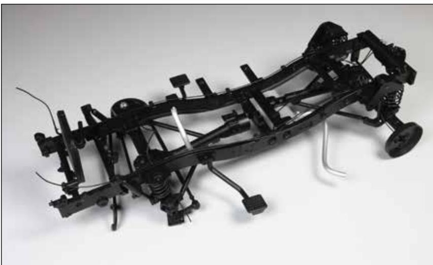
**Der Kühler ist am Leiterrahmen montiert. Der rechtseitige Hydraulikschlauch wurde nach vorne fortgesetzt.**
