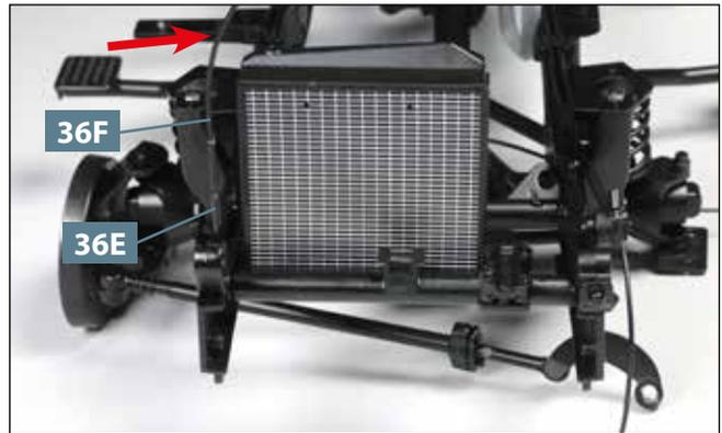
**10** Der montierte Kühler aus der Frontperspektive. Links im Bild das Schlauchstück **36E** und das Schlauchstück **36F**, dessen freies Ende nach oben wegläuft (Pfeil).
