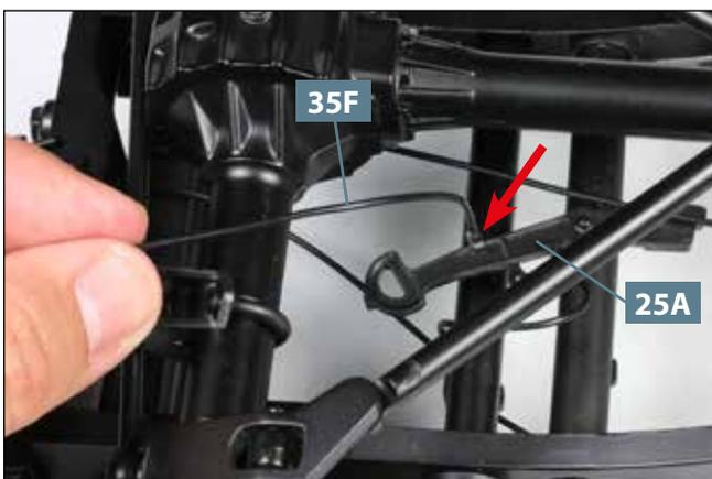
**11** Drehen Sie das Modell auf den Kopf. Nehmen Sie die 145 mm lange Bremsleitung **35F** und befestigen Sie ein Ende am hinteren Zapfen des Zwischenhebels **25A** (Pfeil).
