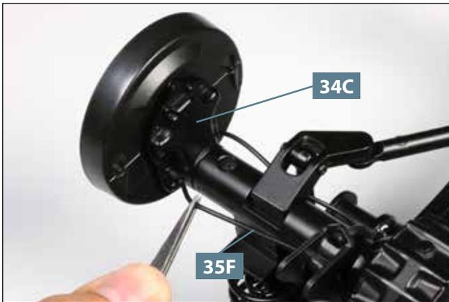
**13** Befestigen Sie das freie Ende der Bremsleitung **35F** am hinteren Zapfen des rechten Vorgelegegehäuses **34C**, wie es das Foto zeigt.
