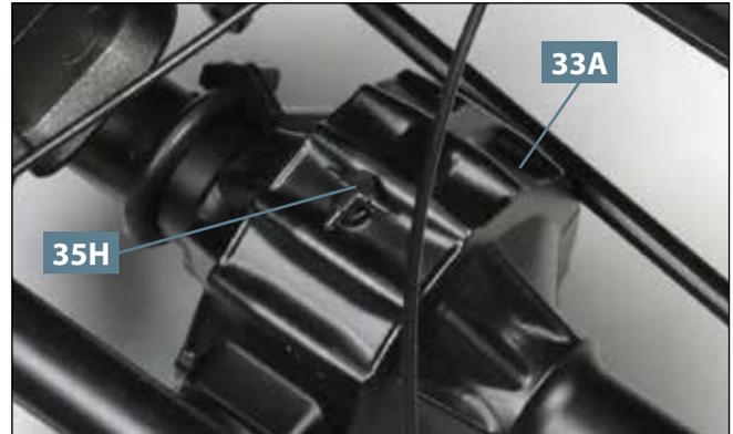
**02** Drücken Sie den dicken Zapfen vom Verteiler **35H** in die Bohrung der Hinterachse **33A**. Achten Sie dabei auf die Ausrichtung des Verteilers.
