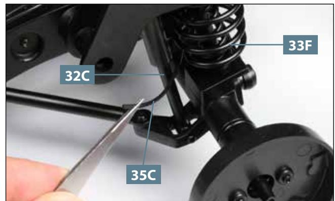
**04** Führen Sie die Bremsleitung **35C** zwischen dem linken hinteren Stoßdämpfer **32C** und der Schraubenfeder **33F** hindurch nach außen.
