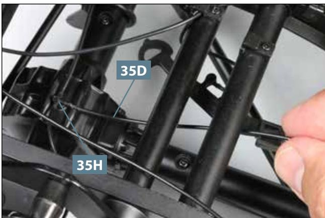
**09** Nehmen Sie die 172 mm lange Bremsleitung **35D** und befestigen Sie ein Ende am nach vorne weisenden Zapfen des Verteilers **35H**, wie abgebildet.
