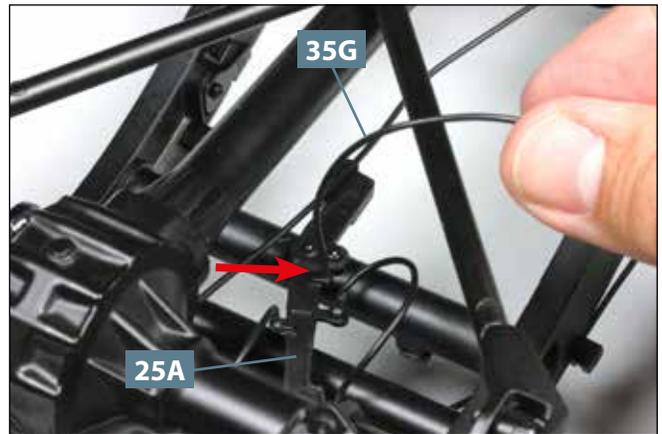
**14** Nehmen Sie die 135 mm lange Bremsleitung **35G** und befestigen Sie ein Ende am vorderen Zapfen des Zwischenhebels **25A**, auf den der Pfeil weist.
