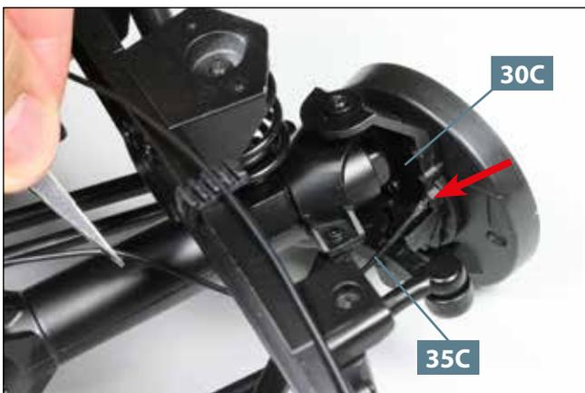
**17** Führen Sie die Bremsleitung **35C** unter dem Längsträger nach außen und befestigen Sie sie am Zapfen des rechten Achsschenkels **30C**, auf den der Pfeil weist.
