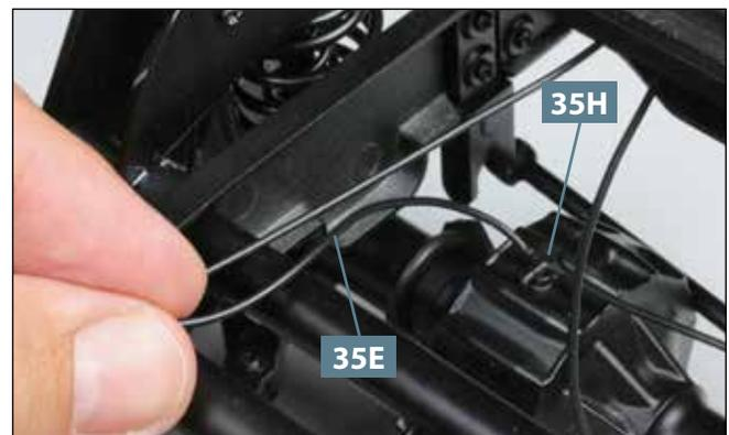
**06** Gleiches Spiel auf der anderen Seite: Nehmen Sie eine der beiden 90 mm langen Bremsleitungen **35E** und befestigen Sie ein Ende am rechten Zapfen des Verteilers **35H**.
