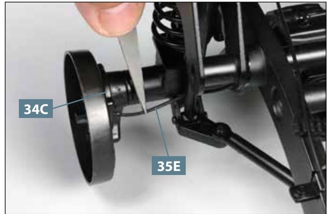
**08** Befestigen Sie das freie Ende der Bremsleitung **35E** am vorderen Zapfen des Vorgelegegehäuses **34C**, wie es das Foto zeigt.
