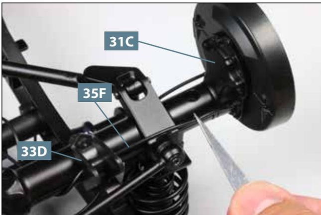
**15** Die Bremsleitung **35F** wird durch die beiden Löcher der linken Aufnahme **33D** zum linken Vorgelegegehäuse **31C** geführt und dort am hinteren Zapfen befestigt.
