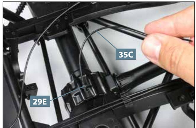
**16** Wechsel zur Vorderachse: Drehen Sie das Modell um und befestigen Sie die verbliebene 112 mm lange Bremsleitung **35C** am rechten Zapfen des Druckreglers **29E**.
