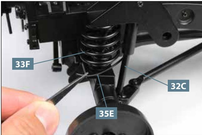
**07** Führen Sie die Bremsleitung **35E** zwischen dem rechten hinteren Stoßdämpfer **32C** und der Schraubenfeder **33F** hindurch nach außen.
