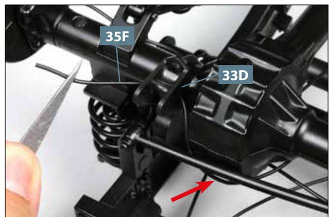
**12** Führen Sie die Bremsleitung **35F** hinter der Hinterachse (Pfeil) zur rechten Aufnahme **33D**: Die Leitung verläuft durch die beiden Löcher der Aufnahme nach außen, wie abgebildet.
