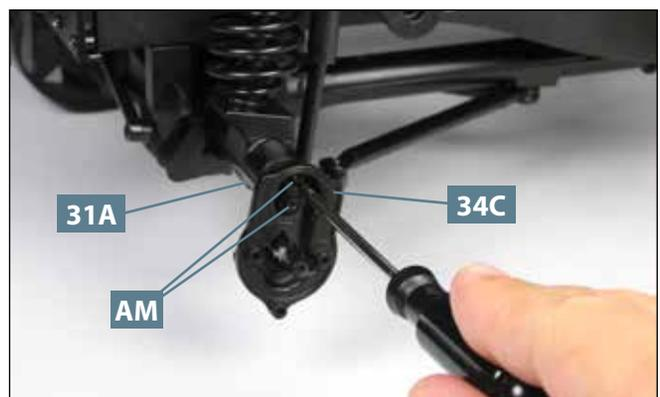
**04** Fixieren Sie das rechte Vorgelegegehäuse **34C** an der Hinterachse **31A**, indem Sie die beiden Schrauben **AM** festziehen, wie abgebildet.
