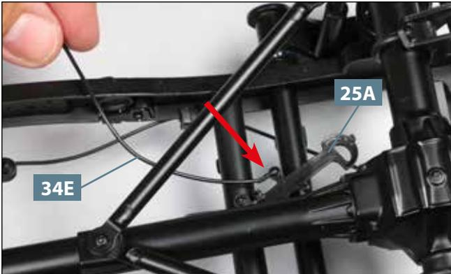
**01** Stellen Sie Ihr Modell vorsichtig auf den Kopf. Befestigen Sie ein Ende vom Handbremsseil **34E** am Zapfen vom Zwischenhebel der Handbremse **25A**, auf den der Pfeil weist.
