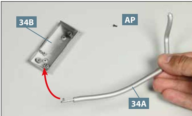
**01** Legen Sie den Auspufftopf **34B** und eine Schraube **AP** bereit. Nehmen Sie das Auspuffrohr **34A** und führen Sie seine Lasche zu den Zapfen des Auspufftopfs, wie angedeutet.
