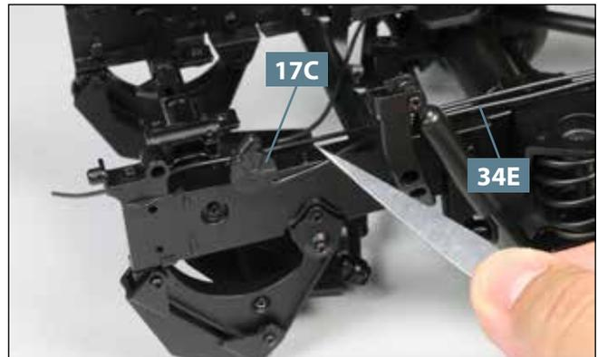
**04** Das vordere Ende des Handbremsseils **34E** befestigen Sie am Zapfen, der sich am Gehäuse der Handbremse **17C** befindet, wie abgebildet.
