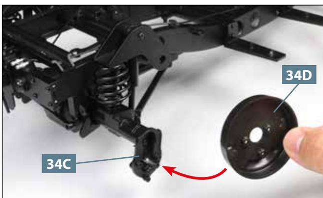
**05** Nehmen Sie die Bremsabdeckung **34D** zur Hand und führen Sie sie zum Vorgelegegehäuse **34C**: Das zentrale Loch der Abdeckung nimmt den großen Zapfen von **34C** auf.
