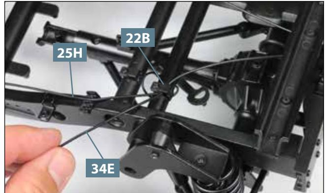
**02** Drehen Sie das Modell wieder um. Fädeln Sie das Handbremsseil **34E** und den langen Hydraulikschlauch **25H** durch die Führung **22B**. Lösen Sie dazu die Schraube leicht an.
