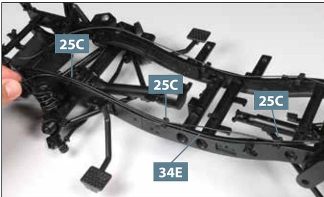
**03** Führen Sie das Handbremsseil **34E** auf dem linken Längsträger nach vorne. Es wird dabei in die zweitäußersten Vertiefungen der drei Schlauchführungen **25C** gedrückt.
