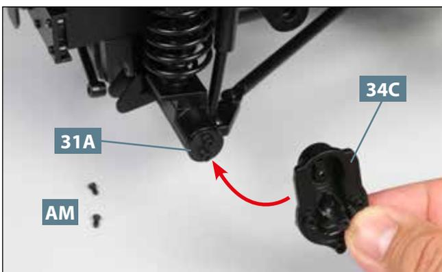
**03** Legen Sie zwei Schrauben **AM** bereit. Nehmen Sie das rechte Vorgelegegehäuse **34C** und führen Sie es zum rechten Ende der Hinterachse **31A**, wie angedeutet.
