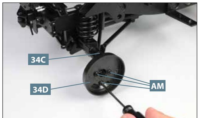
**06** Befestigen Sie die Bremsabdeckung **34D** mit drei Schrauben **AM** am Vorgelegegehäuse **34C**, wie abgebildet.
