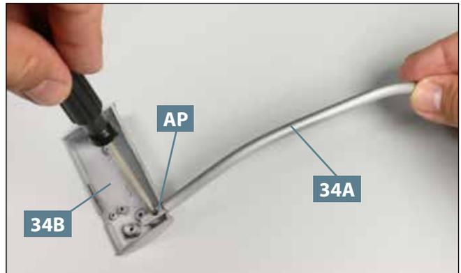
**02** Befestigen Sie das Auspuffrohr **34A** mit der Schraube **AP** am Auspufftopf **34B**, wie abgebildet.
