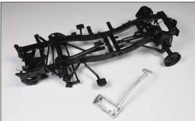
Das Handbremsseil ist verlegt. Das zweite Vorgelegegehäuse ist an der Hinterachse montiert. Der Auspuff wird in der folgenden Bauanleitung komplettiert und am Modell angebracht.
