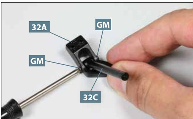
**03** Führen Sie den zweiten Stoßdämpfer **32C** zur Aussparung der rechten Konsole **32A** (mit eingraviertem R). Fixieren Sie auch diesen Stoßdämpfer zwei Schrauben **GM**.
