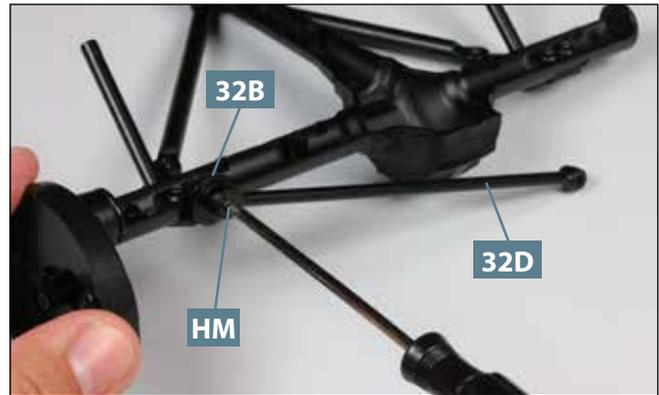
**10** Nehmen Sie den Panhardstab **32D** und befestigen Sie dessen größere Lasche mit einer Schraube **HM** am Zapfen der linken Konsole **32B**, wie abgebildet.
