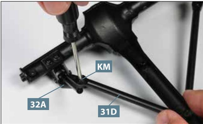
**09** Auf der anderen Seite der Baugruppe wird die rechte Achsstrebe **31D** mit der rechten Konsole **32A** verbunden und ebenfalls mit einer Schraube **KM** fixiert.
