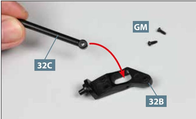
**01** Legen Sie zwei Schrauben **GM** bereit. Nehmen Sie einen der Stoßdämpfer **32C** und führen Sie seine Bohrung zur Aussparung der linken Konsole **32B** (mit eingraviertem L).
