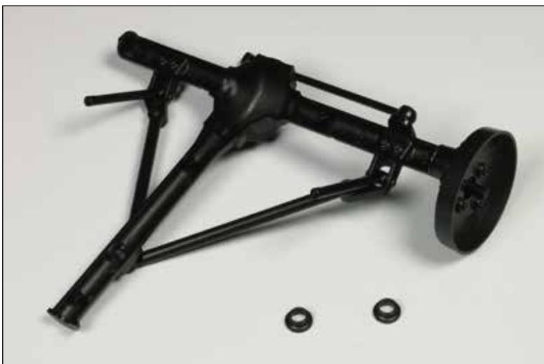
Die beiden Konsolen sind an der Hinterachse befestigt. An ihnen wurden die beiden Achsstreben und der Panhardstab angebracht. Die beiden Federhalter werden erst mit der nächsten Bauanleitung verwendet.
