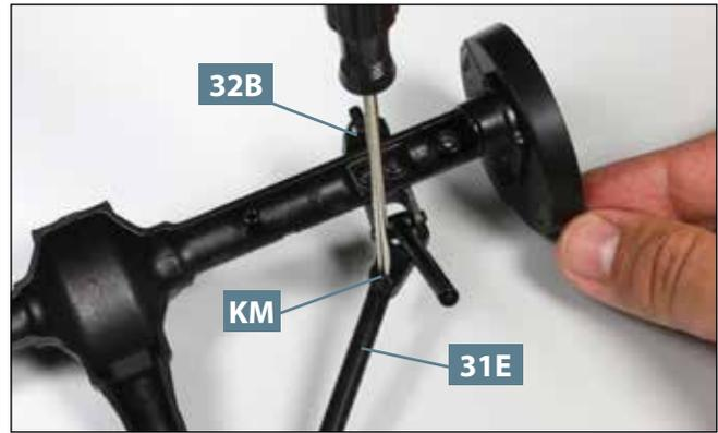
**08** Führen Sie den Zapfen am freien Ende der linken Achsstrebe **31E** in die Bohrung der linken Konsole **32B** und befestigen Sie die Teile mit einer Schraube **KM** aneinander.
