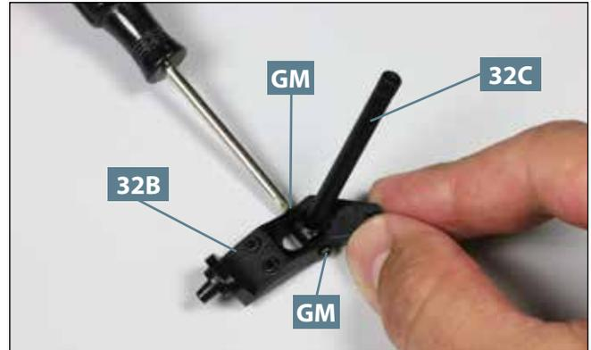
**02** Befestigen Sie den Stoßdämpfer **32C** mit den beiden Schrauben **GM** an der linken Konsole **32B**.
