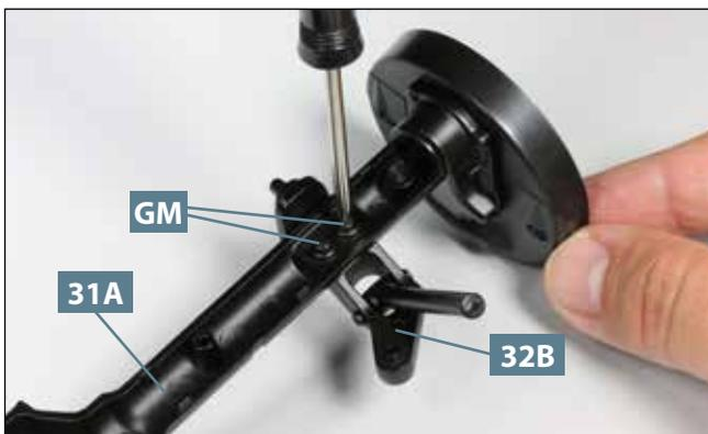
**05** Befestigen Sie die linke Konsole **32B** am Unterteil der Hinterachse **31A**, indem Sie von oben zwei Schrauben **GM** eindrehen, wie abgebildet.
