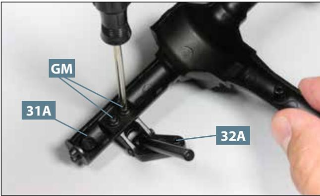
**07** Befestigen Sie die rechte Konsole **32A** mit zwei Schrauben **GM** an der rechten Hälfte der Hinterachse **31A**, wie es das Foto zeigt.
