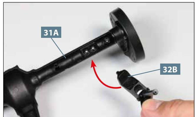
**04** Legen Sie das Unterteil der Hinterachse **31A** auf Ihre Arbeitsplatte. Führen Sie die linke Konsole **32B** von unten zu den Bohrungen an der linken Achshälfte, wie angedeutet.
