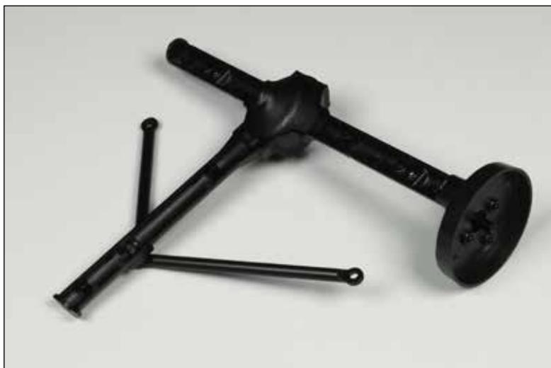
Am Unterteil der Hinterachse bzw. an dem daran bereits befestigten Schubrohr sind zwei Achsstreben sowie das erste Vorgelegegehäuse und eine Bremsabdeckung angebracht.
