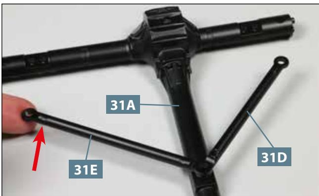
**03** Die rechte Achsstrebe **31E** wird über der Lasche der Achsstrebe **31D** am Zapfen von Teil **31A** eingehängt. Achten Sie auch hier auf die Ausrichtung der Strebe (Pfeil).
