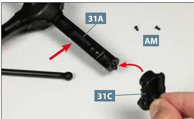
**05** Drehen Sie die Hinterachse **31A** um und führen Sie das Vorgelegegehäuse **31C** zum „langen“ (gerader Pfeil), linken Ende der Achse. Legen Sie zwei Schrauben **AM** bereit.
