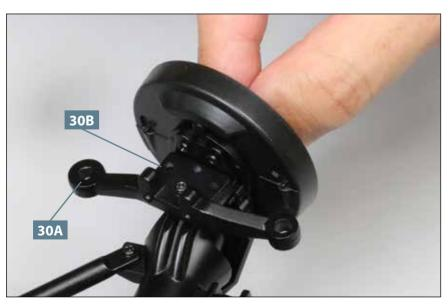
09 Nehmen Sie die Achsschenkel-Bremsabdeckung-Baugruppe und führen Sie sie zum rechten Ende der Vorderachse, sodass sich die drei Bohrungen der Halterung 30B exakt über den Bohrungen des Lenkspurhebels 30A befinden, wie es das Foto zeigt.
