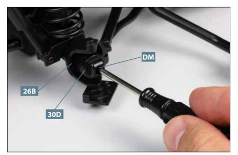
**07** Setzen Sie das Ausgleichsgehäuse **30D** so am linken Ende der Vorderachse **26B** auf, dass seine Aussparung den Zapfen an der Achse aufnimmt. Fixieren Sie das Ausgleichsgehäuse mit der Schraube **DM**.
