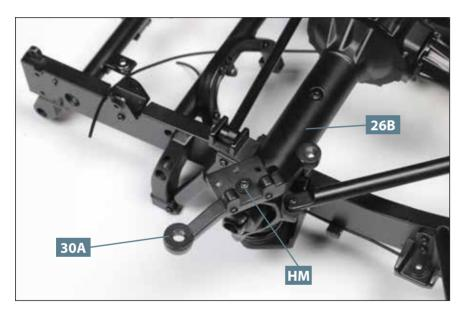
Drehen Sie den Leiterrahmen auf den Kopf und wenden Sie sich der rechten Seite der Vorderachse zu. Setzen Sie den Lenkspurhebel 30A auf den Zapfen am rechten Ende der Vorderachse 26B und fixieren Sie ihn mit einer Schraube HM.
