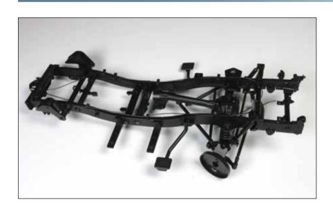
Die Lenkung nimmt allmählich Formen an: Der Lenkspurhebel wurde angebracht und mit der Spur- sowie der Lenkstange verbunden.
