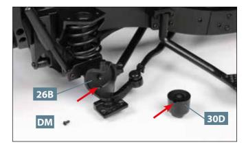
Of Platzieren Sie eine Schraube DM und das Ausgleichsgehäuse 30D vor dem linken Ende der Vorderachse 26B. Die Pfeile weisen auf Zapfen und Aussparung.
