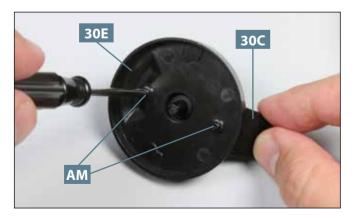
Fixieren Sie den Achsschenkel **30C** an der Bremsabdeckung **30E**, indem Sie zwei Schrauben **AM** eindrehen.
