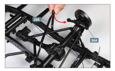
**01** Nehmen Sie die Spurstange **26E** und führen Sie deren freies Ende zur hinteren Bohrung des Lenkspurhebels **30A**, wie es der Pfeil andeutet.
