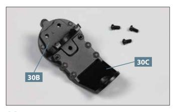
Die Halterung **30B** ist korrekt auf dem rechten Achsschenkel **30C** platziert.
