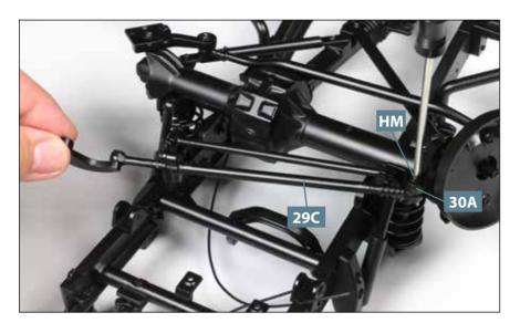
**03** Nehmen Sie die Lenkstange **29C**, die Sie mit der letzten Bauanleitung bereits bearbeitet haben und fügen Sie den Zapfen an ihrem Ende in die vordere Bohrung des Lenkspurhebels **30A** ein. Fixieren Sie die beiden Bauteile mit einer weiteren Schraube **HM** aneinander.
