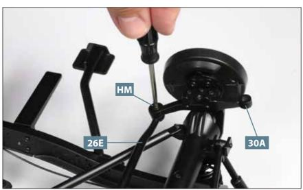
**02** Fügen Sie den Zapfen am Ende der Spurstange **26E** in die Bohrung des Lenkspurhebels **30A** ein und befestigen Sie die Stange mit einer Schraube **HM**.
