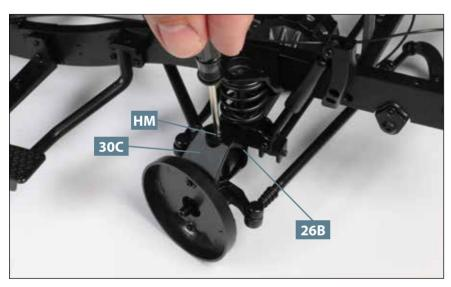
**04** Drehen Sie den Leiterrahmen wieder um und befestigen Sie das obere Ende des Achsschenkels **30C** mit einer Schraube **HM** an der Vorderachse **26B**, wie abgebildet.
