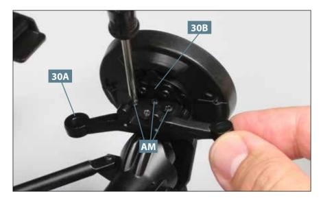
10 Fixieren Sie die Halterung 30B und somit auch den Achsschenkel am Lenkspurhebel 30A, indem Sie drei Schrauben AM eindrehen.
