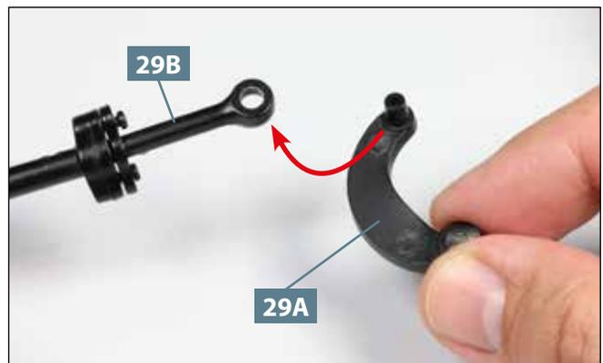
**04** Nehmen Sie den Lenkstockhebel **29A** und führen Sie dessen schmaleren Zapfen zur Bohrung der Verbindungsstange **29B**, wie angedeutet.
