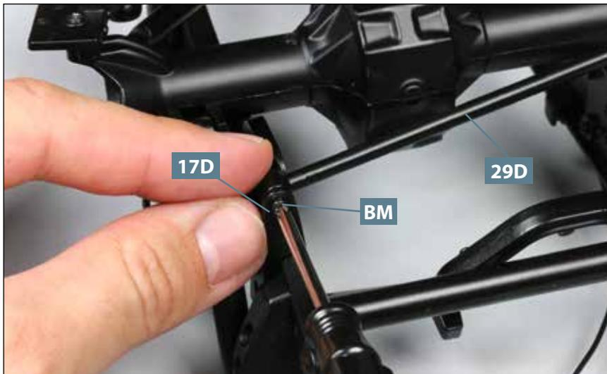
**07** Das andere Ende des Panhardstabs **29D** wird in die Gabel des linken vorderen Querlenkerhalters **17D** eingefügt und an dieser mit einer Schraube **BM** fixiert.
