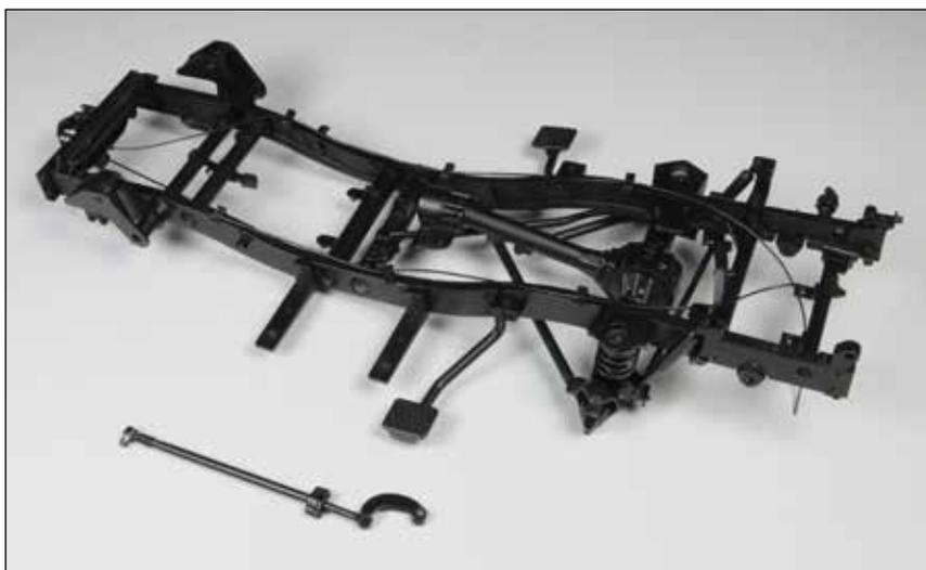
Der vordere Panhardstab und ein Druckregler sind an der Vorderachsen-Rahmen-Baugruppe angebracht. Die Lenkstange wird mit der nächsten Bauanleitung montiert.
