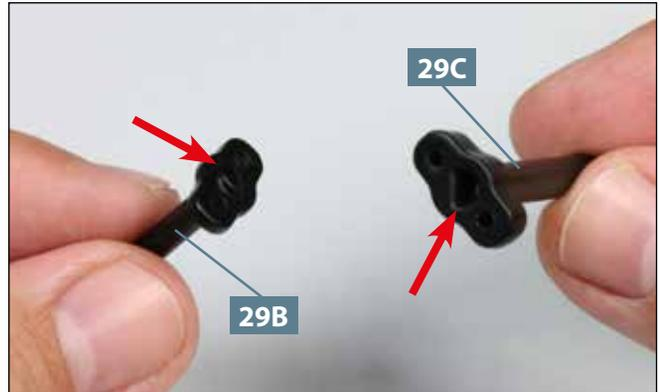
**02** Die Ausrichtung der Teile **29B** und **29C** ist durch den abgeschrägten Zapfen bzw. die halbrunde Bohrung vorgegeben. Die Pfeile weisen darauf.
