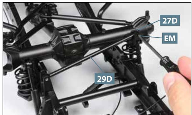
**06** Legen Sie den Leiterraum verkehrt herum auf Ihre Arbeitsplatte. Befestigen Sie den Panhardstab **29D** mit einer Schraube **EM** an der Halterung **27D**.
