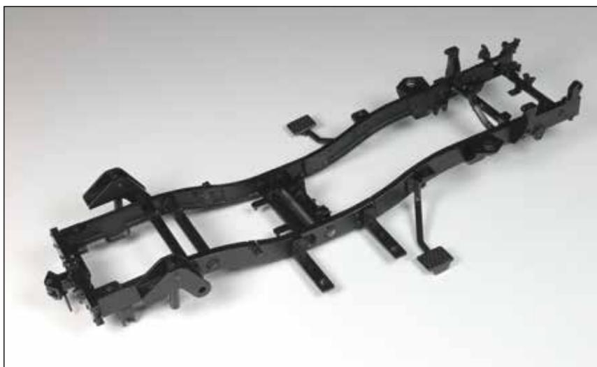
Die Struktur des Leiterrahmens ist nun fast komplett: An seinem hinteren Ende wurde der Schlussquerträger angebracht.
