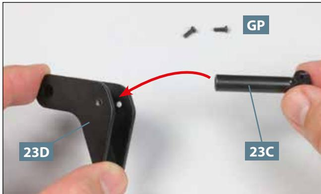
**01** Legen Sie zwei Schrauben **GP** auf Ihre Arbeitsplatte. Fügen Sie einen der Zylinder **23C** in den linken Hinterfederbock **23D** ein, wie durch den Pfeil angedeutet.
