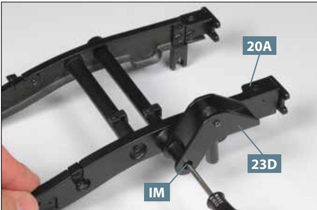
**07** Fixieren Sie den linken Hinterfederbock **23D** am linken Längsträger **20A**, indem Sie eine Schraube **IM** eindrehen, wie es das Foto zeigt.
