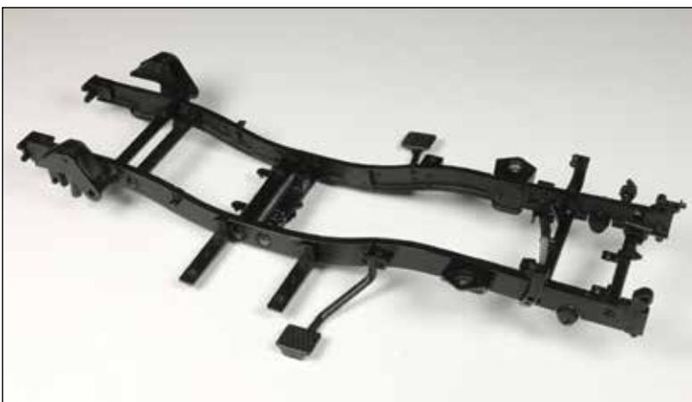
Die beiden Hinterfederböcke und die zwei Halterungen für den Kraftstoffbehälter sind am Rahmen angebracht.
