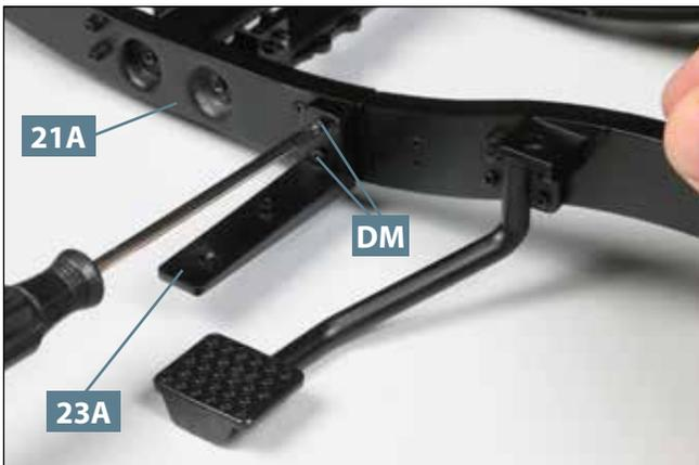
**09** Weiter vorne auf der rechten Rahmenseite wird die erste Halterung für den Tank **23A** mit zwei Schrauben **DM** am rechten Längsträger **21A** angebracht.
