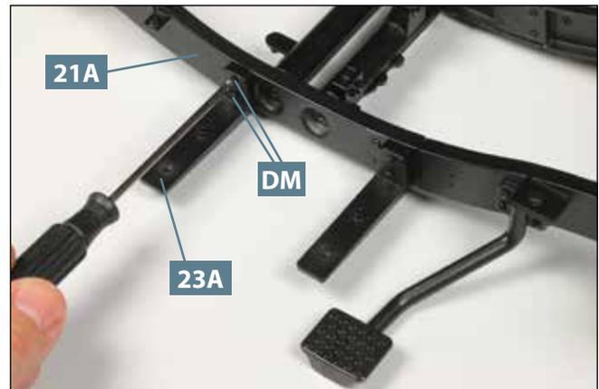
**10** Unweit der ersten wird die zweite Halterung **23A** ebenfalls mit zwei Schrauben **DM** am rechten Längsträger **21A** montiert, wie es das Foto zeigt.
