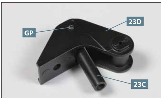
**03** Drehen Sie die Baugruppe **23C/23D** um und ziehen Sie die zweite Schraube **GP** auf der Innenseite des linken Hinterfederbocks **23D** fest.
