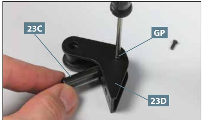
**02** Befestigen Sie den Zylinder **23C** am linken Hinterfederbock **23D**, indem Sie an dessen Außenseite eine der beiden Schrauben **GP** eindrehen, wie abgebildet.
