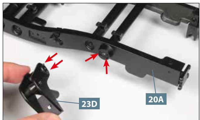
**06** Legen Sie Ihre Rahmenstruktur bereit. Die beiden Zapfen an der Innenseite vom Hinterfederbock **23D** gehören in die beiden Löcher des linken Längsträgers **20A** (Pfeile).
