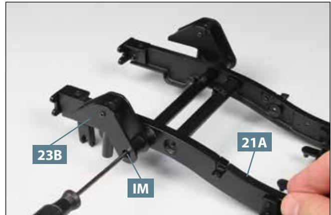
**08** Wechsel auf die rechte Seite der Rahmenstruktur: Fixieren Sie den rechten Hinterfederbock **23B** mit einer Schraube **IM** am rechten Längsträger **21A**.
