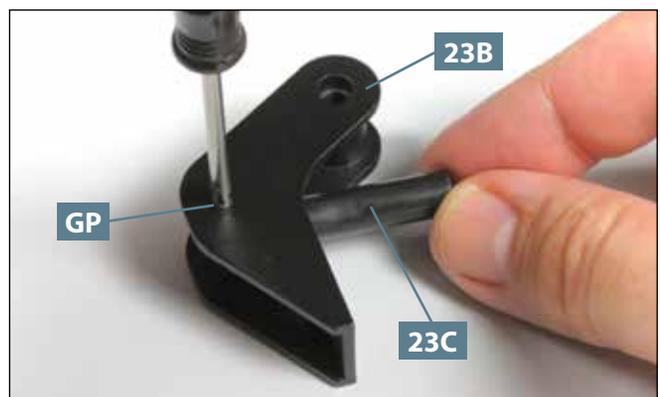
**04** In den rechten Hinterfederbock **23B** wird der zweite Zylinder **23C** eingefügt und von der Außenseite mit einer Schraube **GP** fixiert, wie abgebildet.
