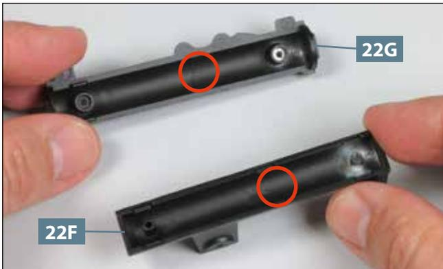
**01** Nehmen Sie die beiden Hälften des dritten Querträgers 22F und 22G zur Hand. Achten Sie darauf, dass die beiden Pfeile (eingekreist) in die gleiche Richtung weisen.
