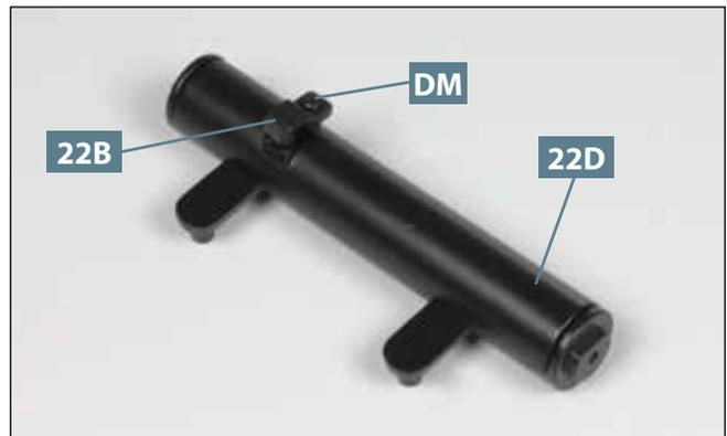
**10** Die letzte Führung **22B** gehört auf den vierten Querträger: Sie wird auf dessen Oberseite **22D** aufgesetzt und mit einer Schraube **DM** befestigt.
