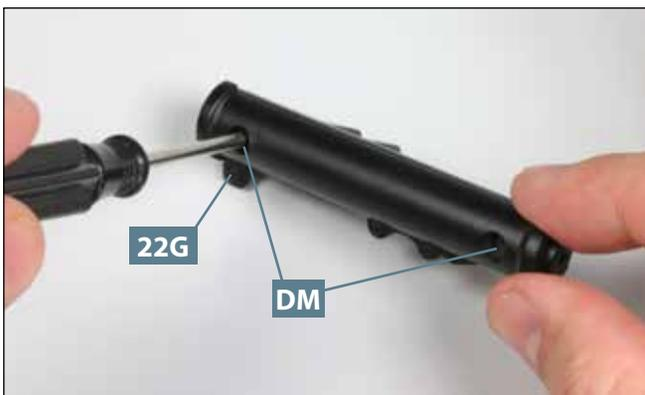
**03** Fixieren Sie die beiden Hälften des dritten Querträgers aneinander, indem Sie die beiden Schrauben DM in die Bohrungen des Unterteils 22G eindrehen.
