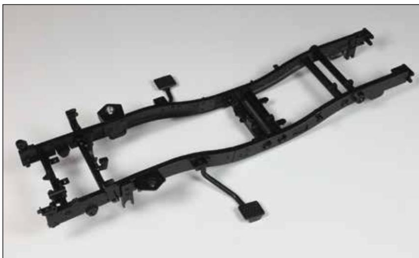
Der Rahmen nimmt immer stärker seine charakteristische Leiterstruktur an: Vier weitere Querträger sind eingefügt und haben die Stabilität des Rahmens beträchtlich erhöht.
