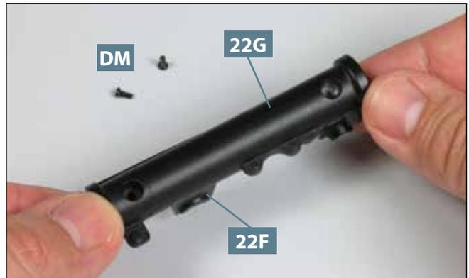
**02** Fügen Sie die beiden Hälften des dritten Querträgers 22F und 22G zusammen, wie abgebildet. Legen Sie zwei Schrauben DM bereit.
