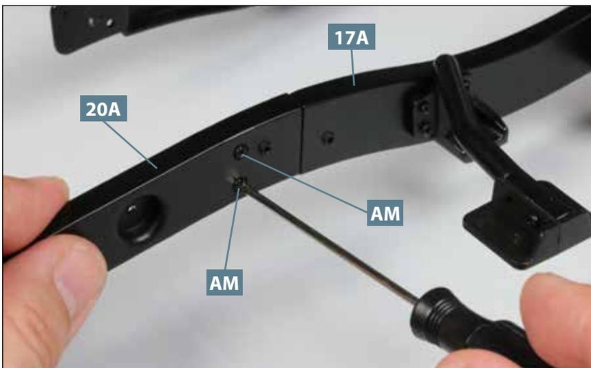
**02** Von außen werden die beiden linken Längsträger **17A** und **20A** ebenfalls mit zwei Schrauben **AM** aneinander fixiert, wie es das Foto zeigt.
