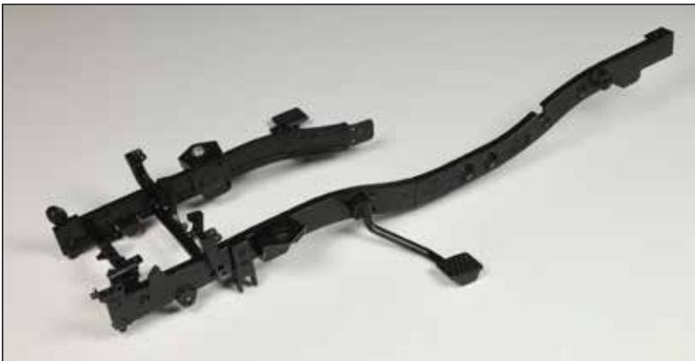
Der Leiterraum wächst weiter: Der hintere Abschnitt des linken Längsträgers wurde montiert. Zudem wurde das Zapfwellenlager am vordersten Querträger angebracht.
