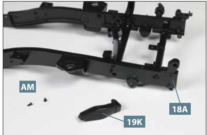
**06** Drehen Sie die Struktur des Leiterrahmens um und platzieren Sie den rechten Stoßdämpferhalter **19K** und zwei weitere Schrauben **AM** vor dem rechten Längsträger **18A**.
