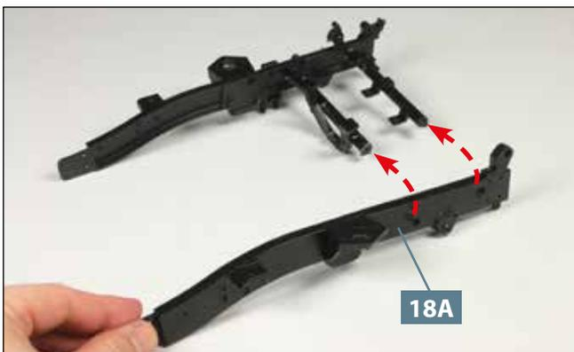
**01** Nehmen Sie den rechten vorderen Längsträger **18A** zur Hand und führen Sie ihn zu den freien Enden der beiden Querträger, wie angedeutet.
