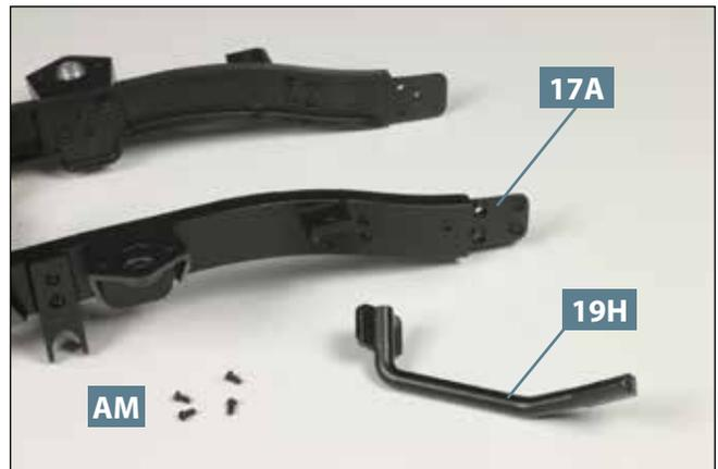
**08** Zurück auf die linke Seite des Leiterrahmens: Legen Sie den linken Aufstieg **19H** und vier Schrauben **AM** vor das hintere Ende des linken Längsträgers **17A**.
