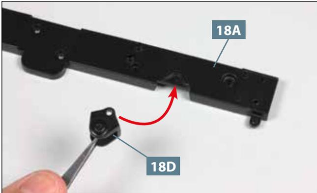
**01** Legen Sie den rechten vorderen Längsträger **18A** auf Ihre Arbeitsplatte. Führen Sie eine der beiden Bügelhalterungen **18D** zur Aussparung des Längsträgers, wie angedeutet.
