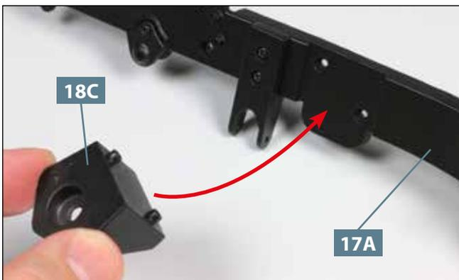
**03** Führen Sie den verbliebenen Vorderfederbock **18C** von außen zum Längsträger **17A**: Seine beiden Zapfen gehören in die zwei Löcher am Längsträger.
