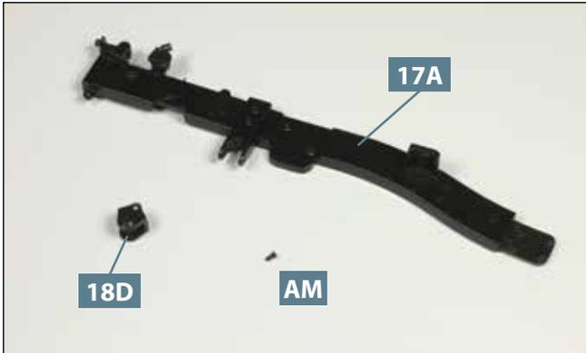
**01** Legen Sie den linken vorderen Längsträger **17A** sowie die verbliebene Bügelhalterung **18D** und eine Schraube **AM** auf Ihre Arbeitsplatte.
