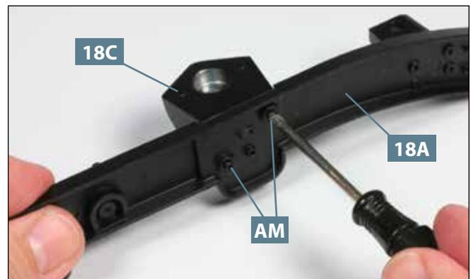
**06** Fixieren Sie den Vorderfederbock **18C** mit zwei Schrauben **AM**, die Sie an der Innenseite des Längsträgers **18A** eindrehen, wie es das Foto zeigt.
