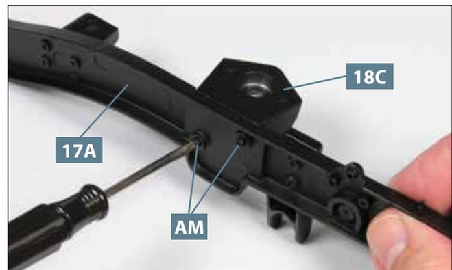
**04** Halten Sie den Vorderfederbock **18C** in Position und drehen Sie die Baugruppe um. Fixieren Sie **18C** mit zwei Schrauben **AM** am Längsträger **17A**, wie abgebildet.
