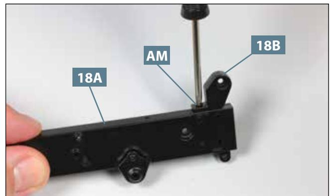
**04** Fixieren Sie die Windenhalterung **18B** am Längsträger **18A**, indem Sie die Schraube **AM** in der Bohrung der beiden Teile festziehen, wie abgebildet.
